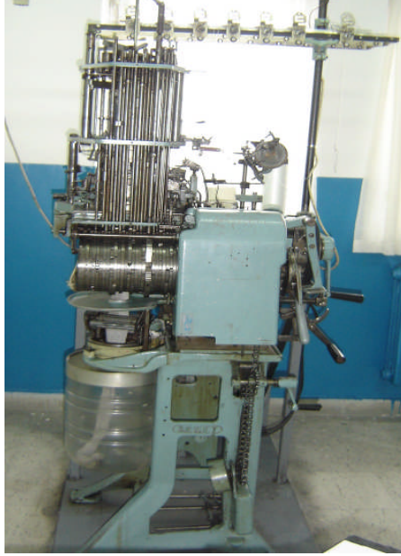
Resim 2.23: Çift silindirli mekanik çorap örme makinesi
