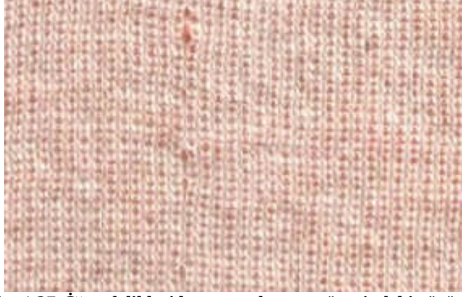
Resim 1.27: İğne delikleri hatasının kumaş yüzeyindeki görünümü
