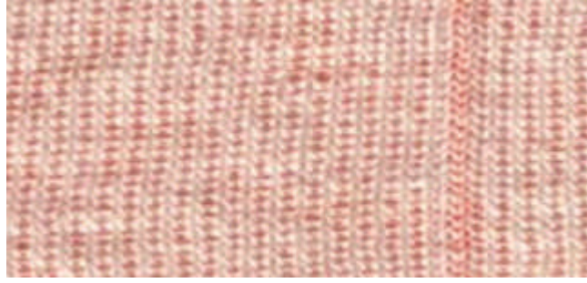
Resim 1.22: Yeni takılmış iğnenin kumaş yüzeyindeki görünümü
