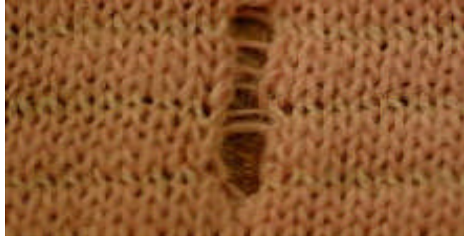
Resim 1.20: Kırık iğne ayağı sonucu kumaş yüzeyindeki görünüm
