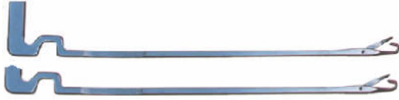
Resim 1.19: Sağlam olan ve kırık olan iğne ayağı görünümü
