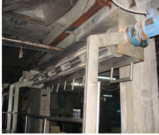
Resim 2. 1. Kumaş yükleme boşaltma aparatı
