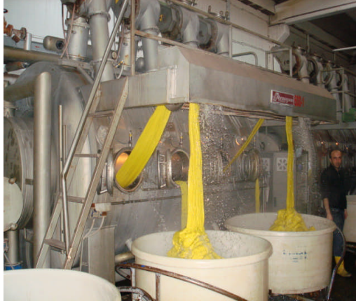
Resim 1. 13. Kumaş yükleme boşaltma aparatı
