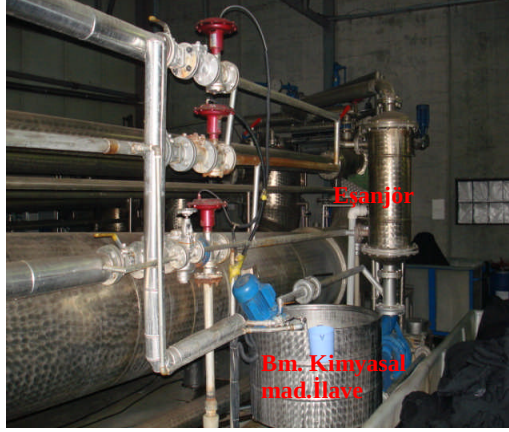
Resim 1. 4: Boyarmadde ve kimyasal madde ilave tankı – eşanjör
