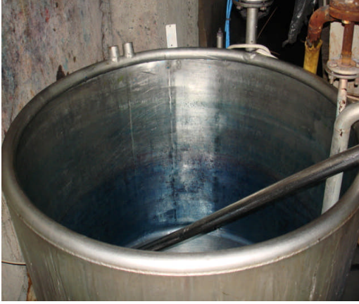
Resim 2. 4: Boyarmadde kimyasal madde ilave tankı ve ayar vanası
