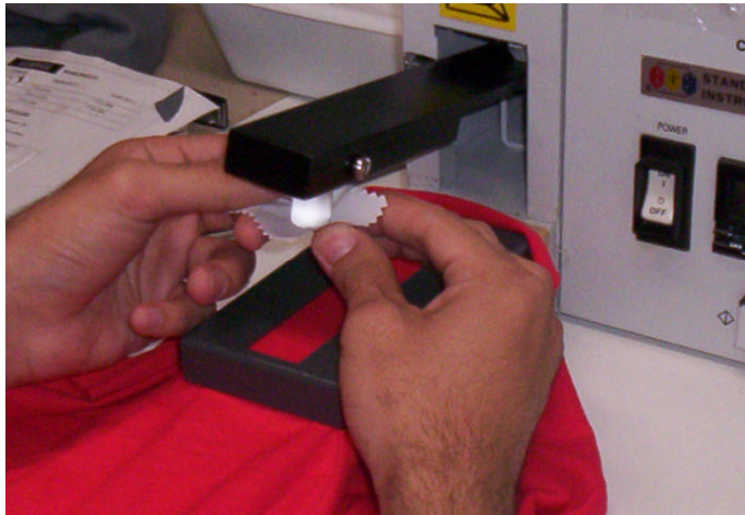
Resim 2.3: Sürtme bezinin sürtme ucuna takılışı
