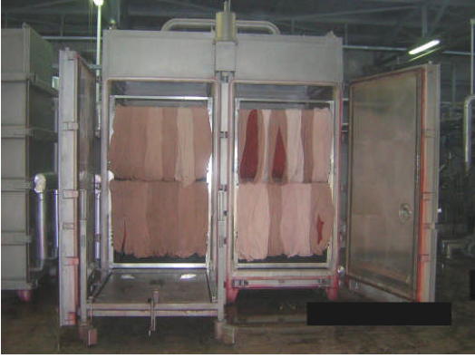
Resim 1.10–11: HT Çile iplik boyama makinesi ve boyanmış çileler
