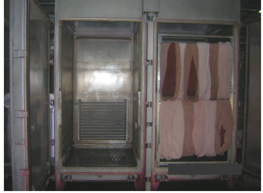
Resim 1.10–11: HT Çile iplik boyama makinesi ve boyanmış çileler
