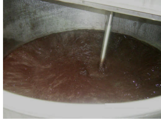
Resim 1.8: İlave tankında boyarmadde çözülmesi
