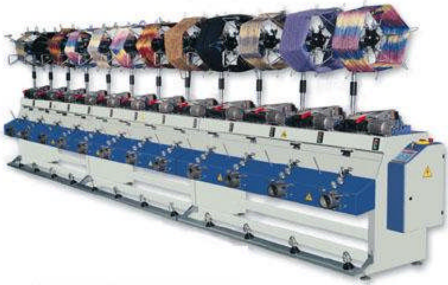
Resim 2.2: Bobin boyama için çile hâlindeki ipliğin bobinlenmesi
