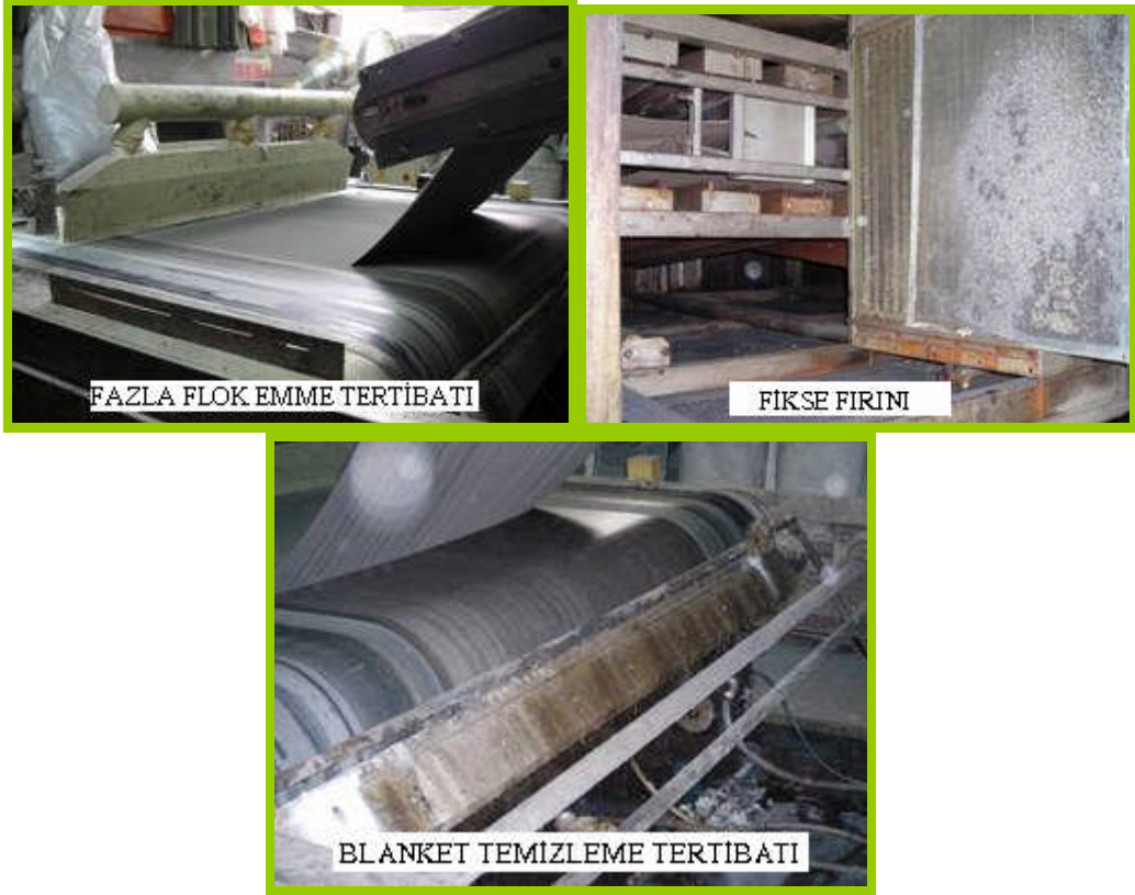
Resim 1.2: Flok Baskı Makinesinin Kısımları
