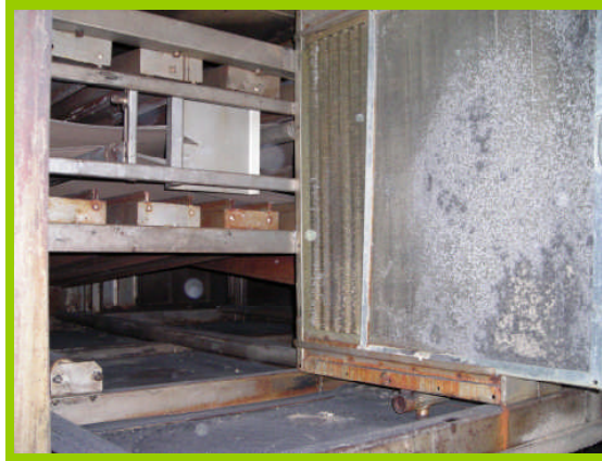
Resim 1.4: Flok baskı makinesi fikse fırını
