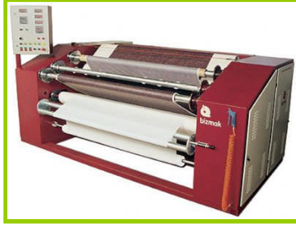
Resim 2.4: Transfer baskı makinesi
