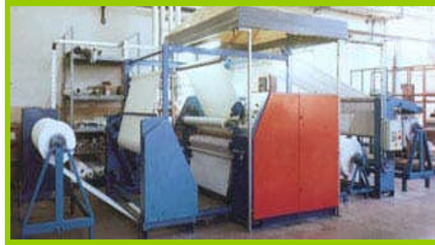
Resim 2.3: Transfer baskı makinesi
