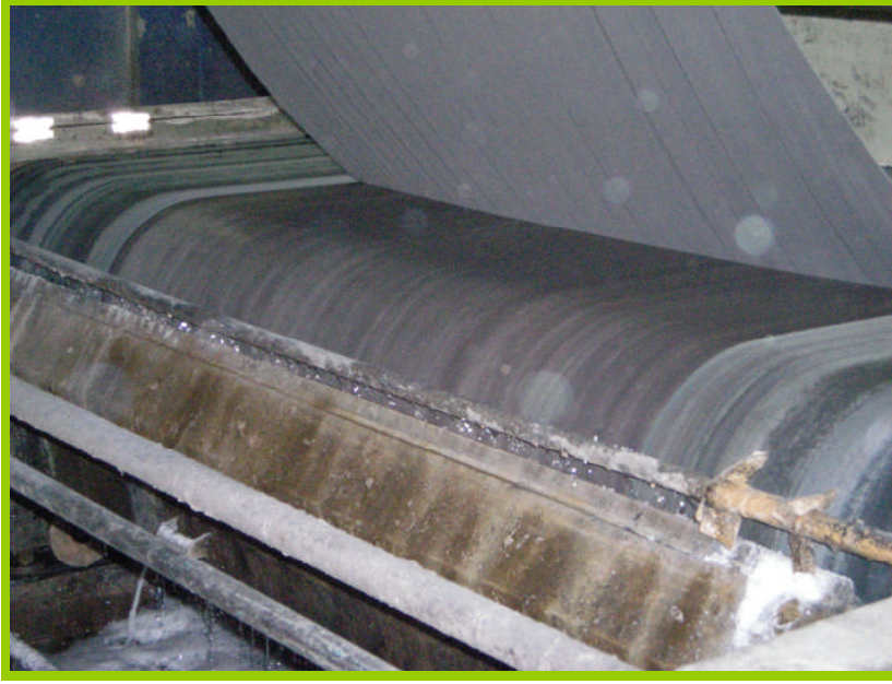
Resim 1.5: Flok baskı makinesi blanket temizleme
