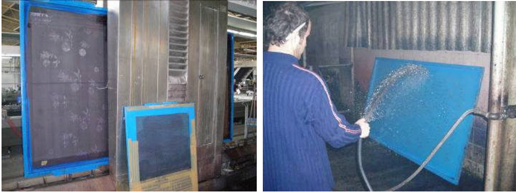
Kalıplar elle veya makine ile yıkanır ve kurutulur Resim 3.2: Baskı sonrası kalıpların bakımı ve temizliği
