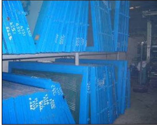
Resim 1.6:Film druk baskı kalıpları
