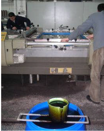
Resim 1.10: Film druck baskıda baskı patı besleme
