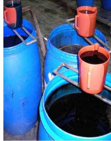
Resim 1.10: Film druck baskıda baskı patı besleme
