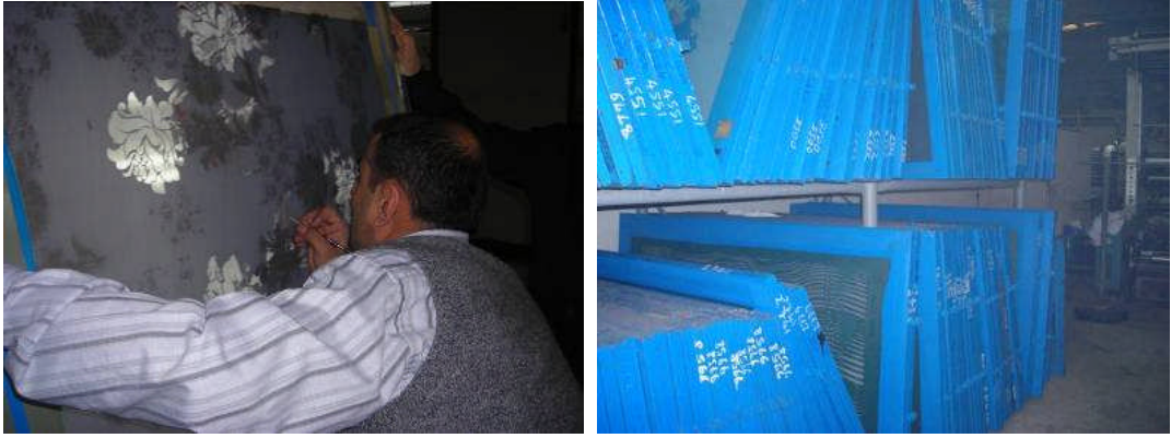
Tamiri bakımı yapılır depolanır Resim 3.3: Baskı sonrası kalıpların tamiri ve depolanması
