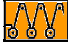
Şekil 1.1: Yarım selanik örme kumaşın 1. ve 2. sıra teknik ilmek çizimi
