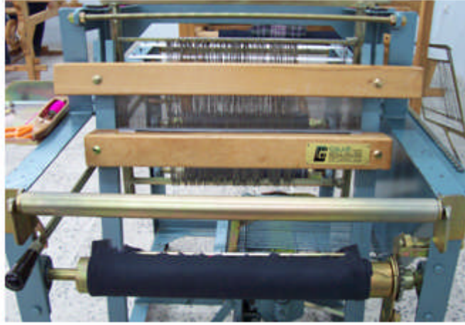
Resim 1. 8: Tefe, tarak, kumaş köprüsü ve kumaş levendi
