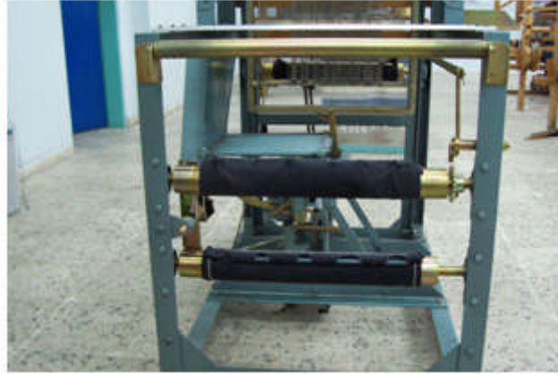
Resim 1. 5: Çözü levendi ve çözü köprüsü
