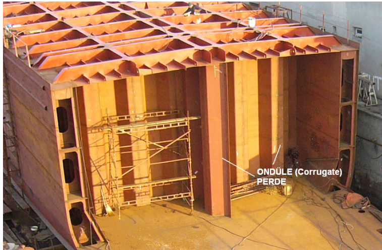
Resim 3.4: Enine ve boyuna yerleştirilmiş ondüle perdeler
