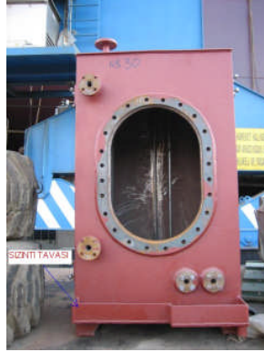
Resim 1.3: Tank üzerine monte edilmiş sızıntı tavaşı
