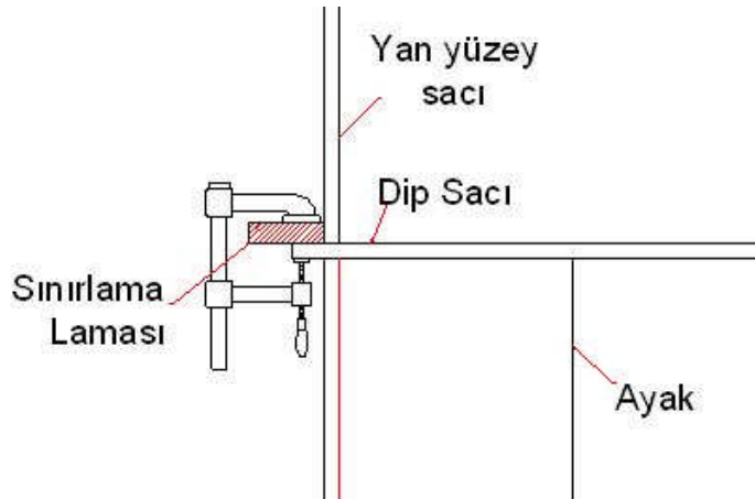
Şekil 2.2: Dip sacı kenarına işkence ile sınırlayıcı sabitlenmesi
