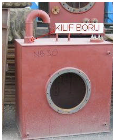
Resim 1.4: Kılıf boru uygulaması
