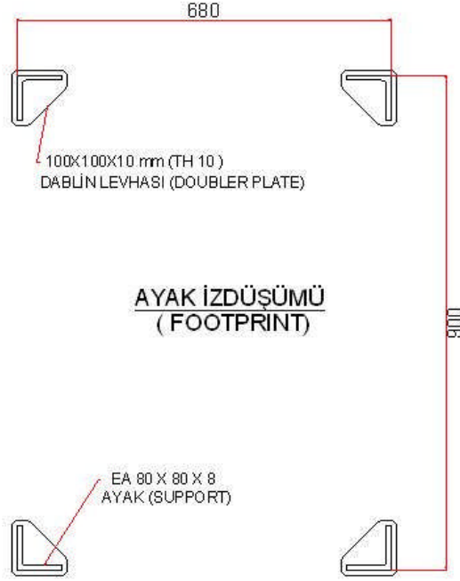
Şekil 2.4: Tank ayak izdüşüm detayı
