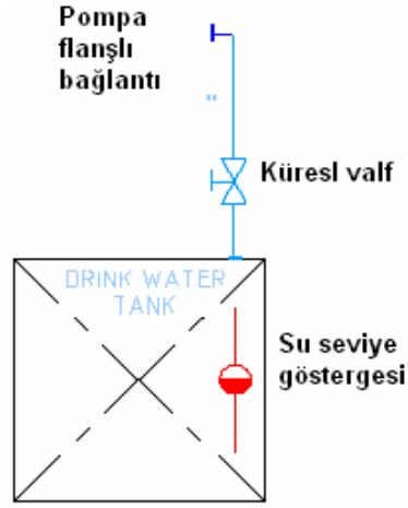
Şekil 2.1: İçme suyu tankı güverte montajı
