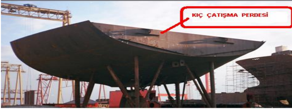
Resim 4.1: Kıç çatışma perdelerin ön imalat aşaması
