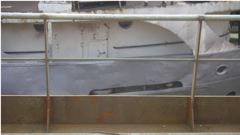
Resim 2.2: Vardevela güverte bağlantısı
