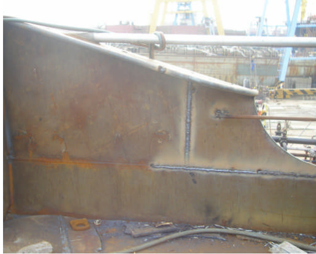
Resim 2.4: Parampet ve vardevela bağlantısı
