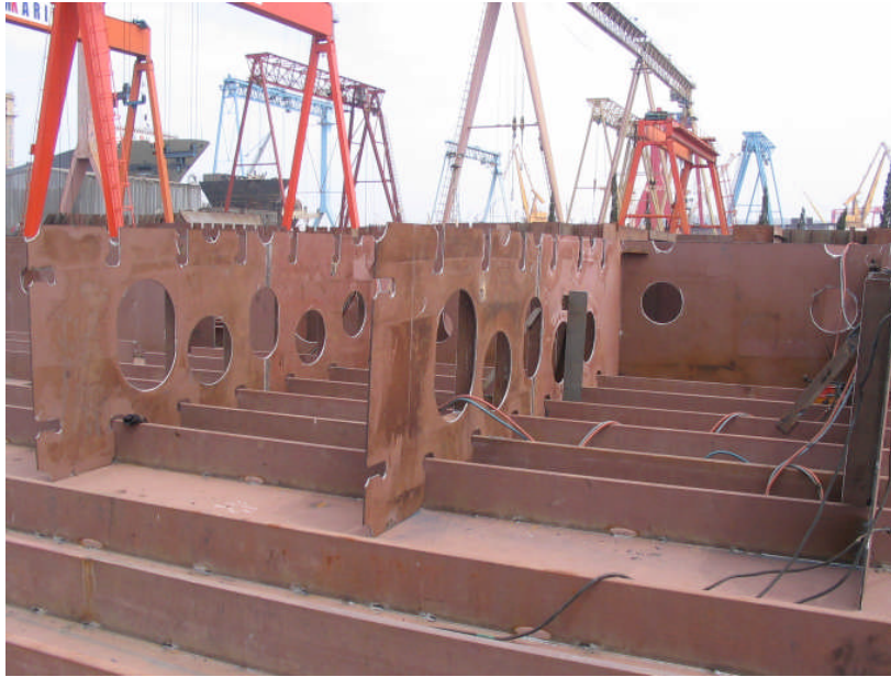
Resim 1.3: Tulaniler ve dolu döşeklerin panel üzerinde kaynatılışı
