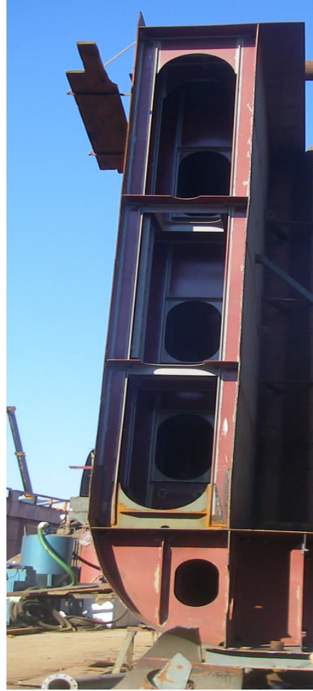
Resim 2.2: Ambar yan bloğunu innerbottom sacına kaynak edilmesi
