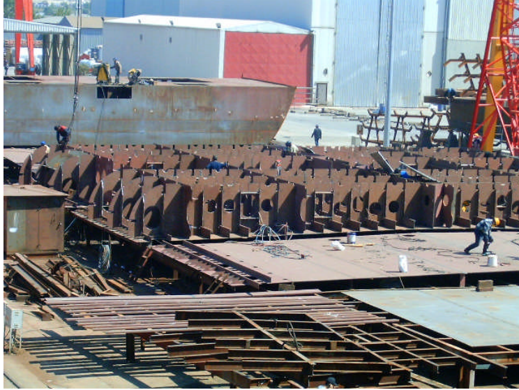
Resim 1.4: Jigler üzerinde ters olarak inşa edilen bir double bottom bloğu
