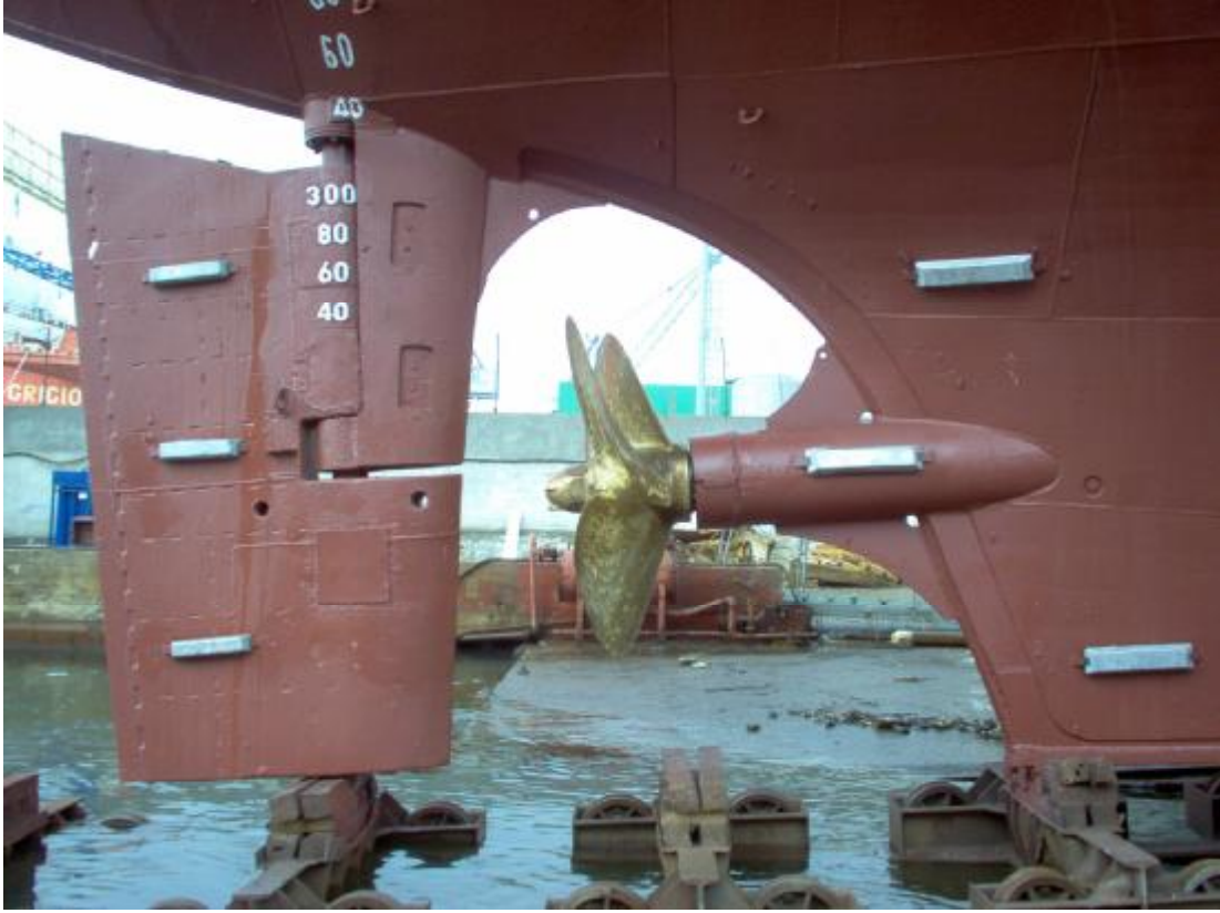
Resim 1.3: Dümen yelpazesi ve pervane
