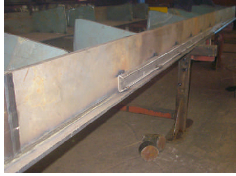
Resim 2.11: Derin tülanelerin montajı
