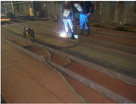
Resim 2.10: Tülanilerin saclara kaynatılması
