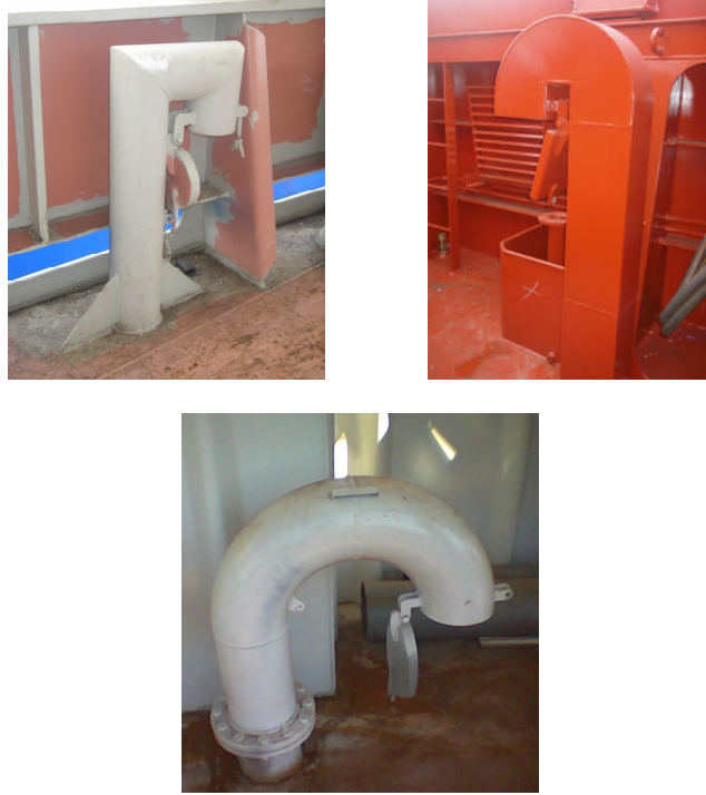
Resim 1.1: Güverte üstü manikalar
