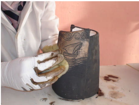
Resim 1.26: Ürünün üzerindeki oksitlerin silinmesi
