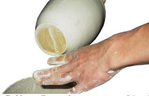
Resim 1.12: Daldırma ile astarlanan yarı mamul ün çıkartılması
