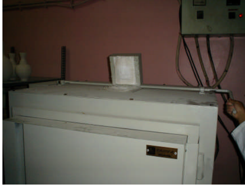
Resim 2.2: Fırın bacası yakma öncesinde açılır.
