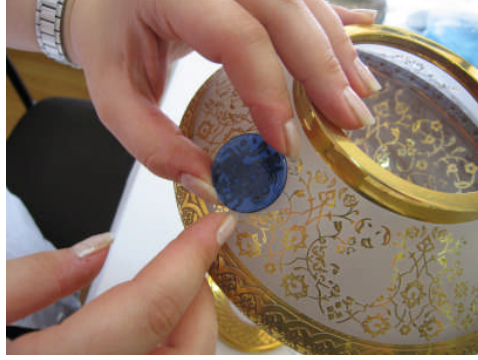
Resim 1.3: Cam üzerine cam yapıştırma
