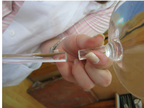
Resim 2.1: Cam parçaları birbirine yapıştırma
