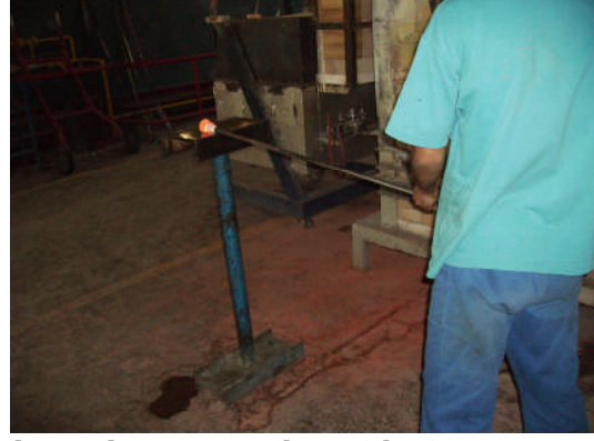
Resim 2.3: Ezme sehpasında ezme yuvarlatma işlemi
