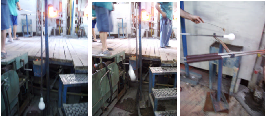
Resim 3.14: Askıdaki fıska, askıdan alınan fıska, fıska sapının ıslatılması
