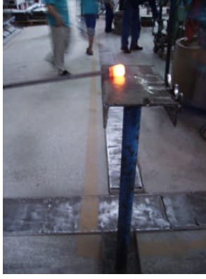
Resim 2.3: Ezme sehpasında ezme yuvarlatma işlemi
