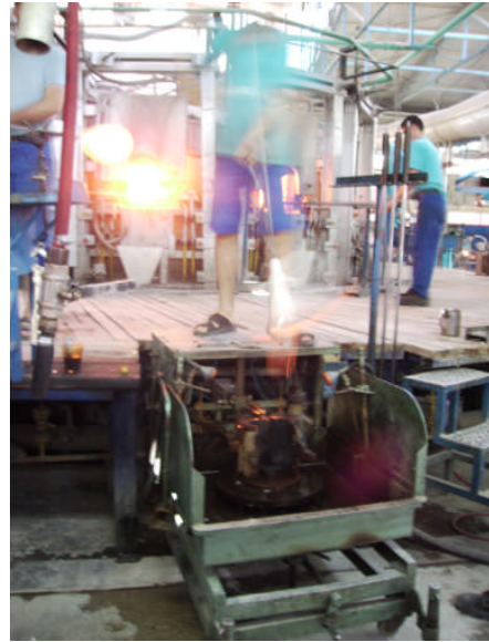
Resim 4.3: Sıcak camın dip kısmının düzeltilmesi ve kalıba girmeye hazırlanması
