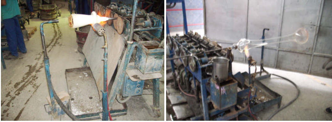
Resim 5.7: Hava hortumu ile soğutmak
