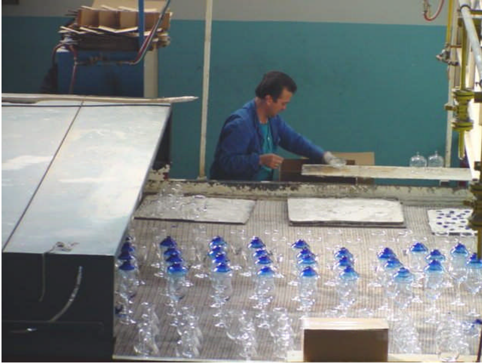
Resim 7.9: Kapeleri kesilecek ürünlerin tavlama fırını sonundan çıkışı
