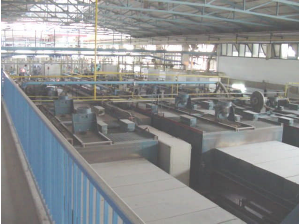
Resim 7.8: Sürekli tavlama fırınlarının üstten görünüşü
