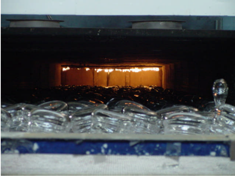
Resim 7. 6: Tavlama fırını soğuktan ısıya doğru tünel görüntüsü
