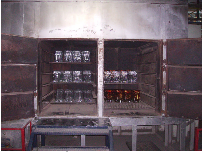
Resim 7.2: Ürün yerleştirilmiş sabit tavlama fırını
