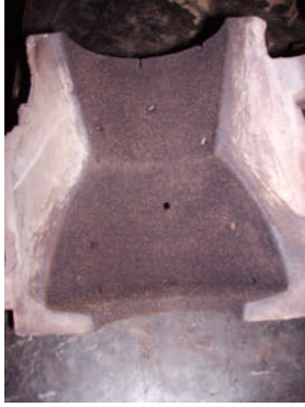
Resim 4.13: Mantarlı kalıp yüzeyleri görüntüsü a) Yanmamış b) Yanmış
