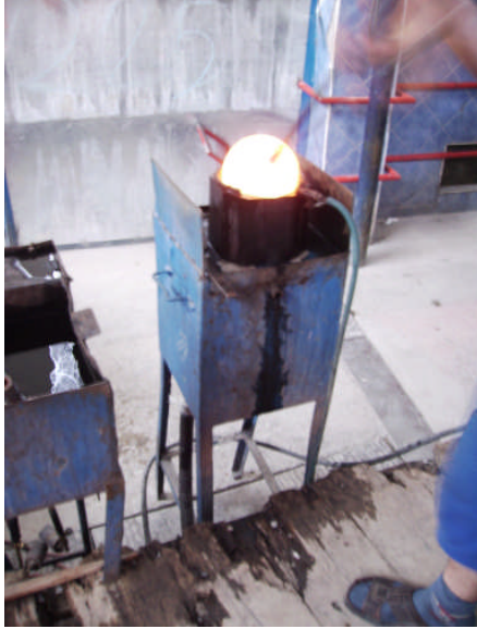
Resim 3.6: Yer kepçesinde çalışma
