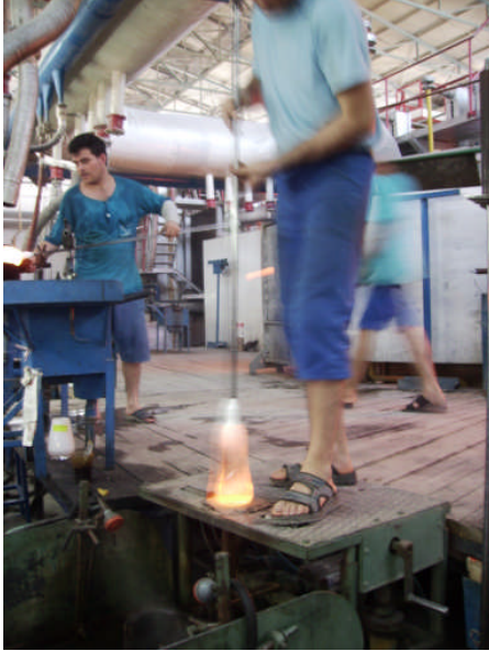
Resim 4.3: Sıcak camın dip kısmının düzeltilmesi ve kalıba girmeye hazırlanması
