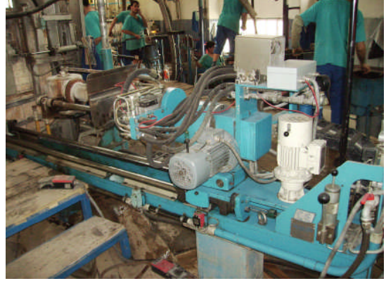
Resim 1.11: Vakumla cam alma makinesi
