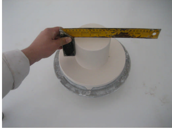
Resim 2.14: Silindirin üst yüzeyinin istenilen ölçüye getirilmesi
