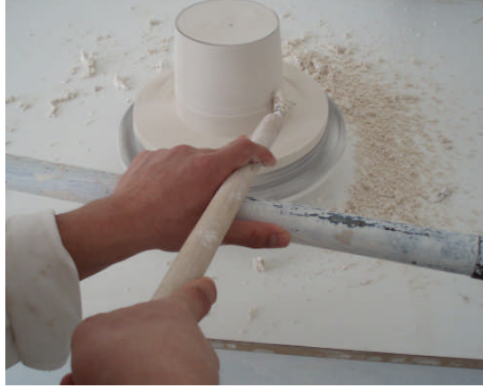
Resim 2.10: Silindirin gövdesini şekillendirme
