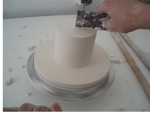
Resim 2.16: Siftire ile rtulama
