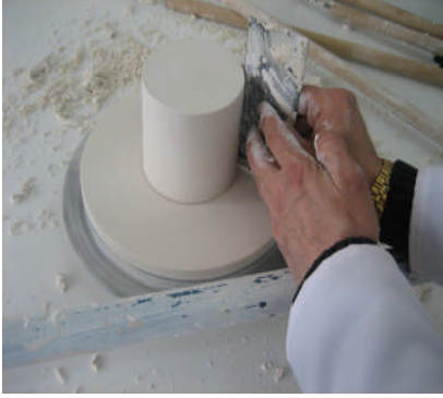
Resim 2.16: Siftire ile rtulama
