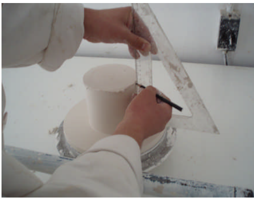
Resim 2.11: Yükseklik ölçüsünün işaretlenmesi
