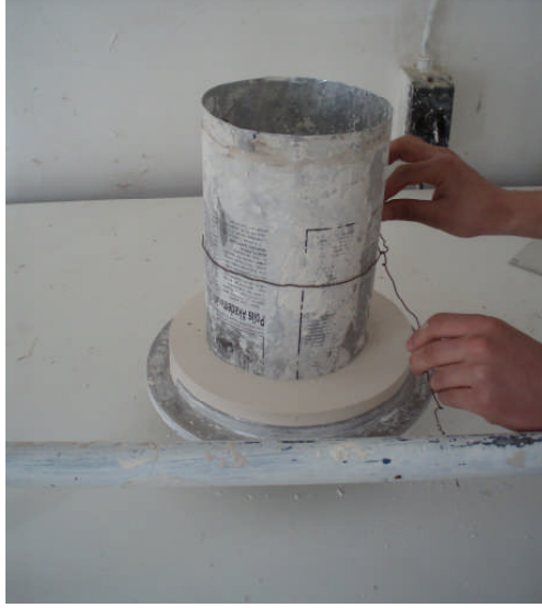
Resim 2.4: Esnek plakayı tel ile bağlama
