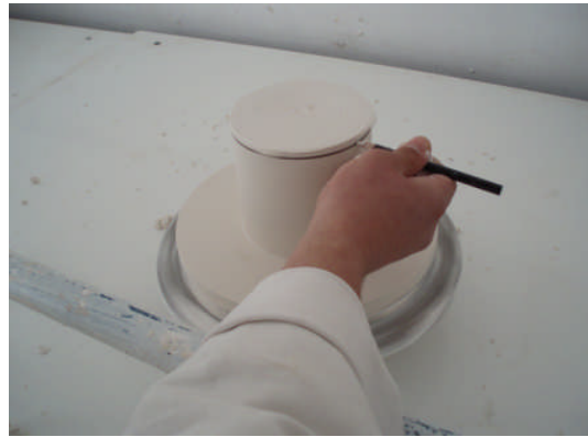
Resim 2.11: Yükseklik ölçüsünün işaretlenmesi
