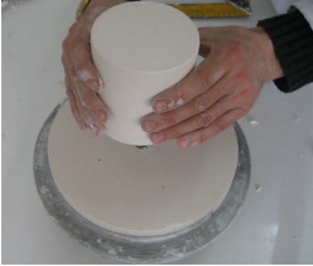
Resim 2.18: Silindiri torna aynasında çıkarma
