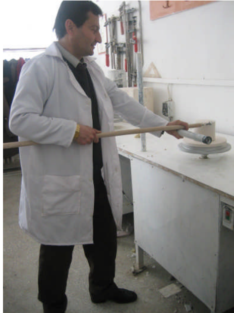
Resim 2.9: Torna bıçağının doğru tutuş şekli
