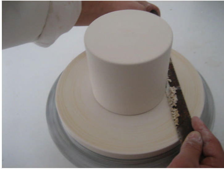
Resim 2.19: Torna aynasından silindir modeli keserek çıkarma
