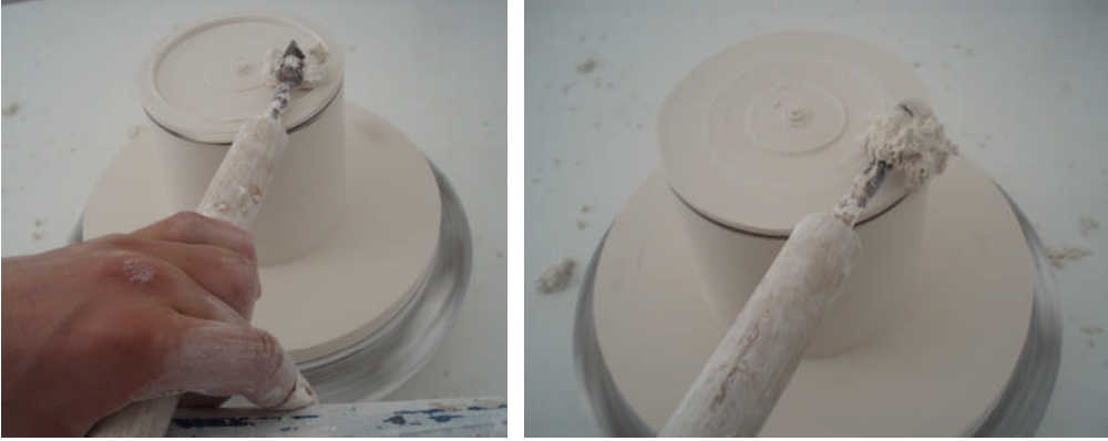
Resim 2.13: Silindirin üst yüzeyini tıraşlama
