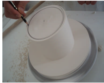
Resim: 2.7: Çap ölçüsünü işaretleme
