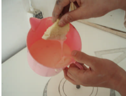
Resim 2.1: Arap sabunu ile yalıtma
