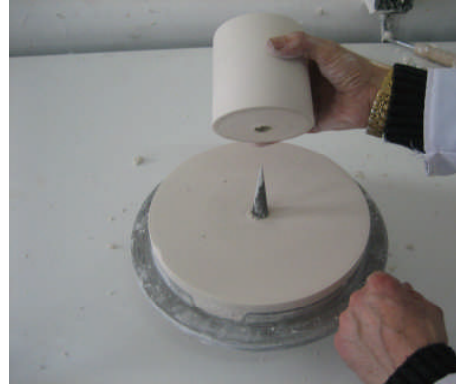
Resim 2.18: Silindiri torna aynasında çıkarma
