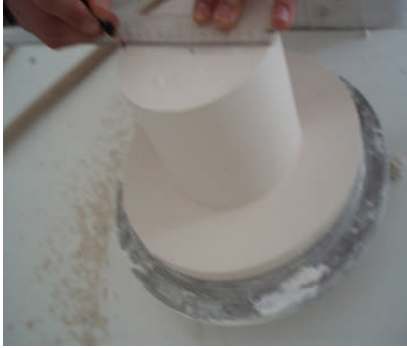
Resim: 2.7: Çap ölçüsünü işaretleme
