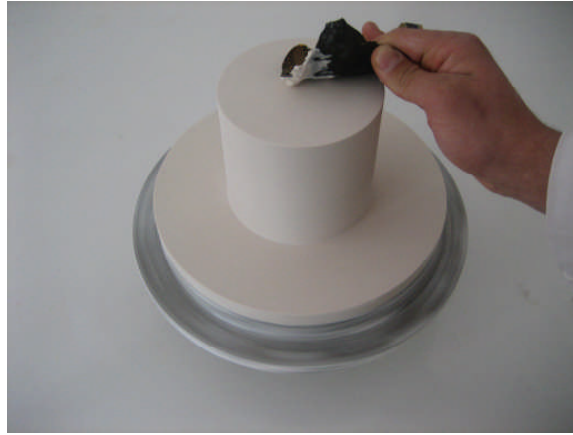
Resim 2.17: Zımpara ile rtulama
