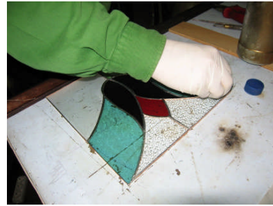
Resim 2.16: Patina suyu siyah veya bakır rengi hangisi tercih edilirse yine yumuşak bir fırça veya sünger ile lehim konturlarının üzerine sürülür.
