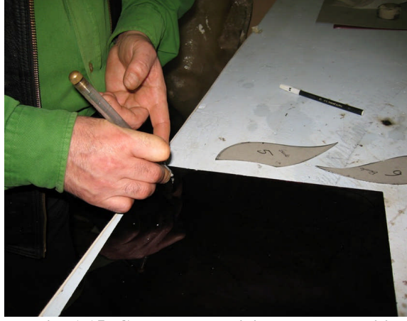
Resim.1.15: Cam, elmasla çizilen yerden kesilir.
