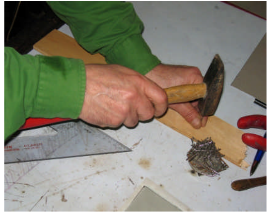
Resim 2.7: Çaktığımız çıtalarmın gönye ile dik açı oluşturup oluşturmadığı kontrol edilir ve sabitlenir.
