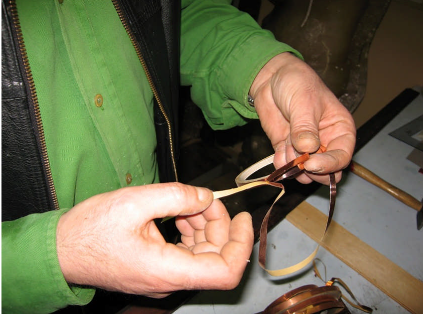
Resim.1.1.1 Cam kalınlığına göre bakır folyolar kullanılır. Kalın camlarda kalın, ince camlarda ince folyo kullanılır.
