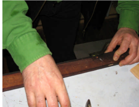
Resim 2.6:Çalışma masasına dik açı oluşturacak şekilde çitalar çivilenir.
