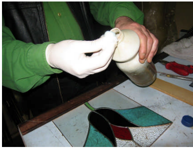
Resim 2.16: Patina suyu siyah veya bakır rengi hangisi tercih edilirse yine yumuşak bir fırça veya sünger ile lehim konturlarının üzerine sürülür.
