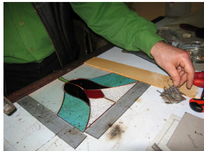
Resim 2.8: Cam parçaları, çerçeve üzerine desene göre yerleştirilir ve sabitlenir.
