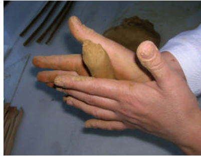
Resim 1.1: Çamurun iki el arasında inceltilmesi
