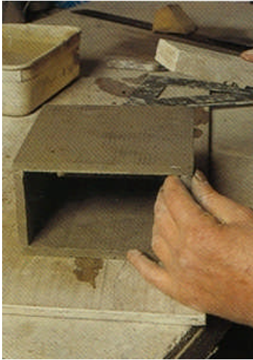
Resim 1.9:Dördüncü parçanın birleştirilmesi
