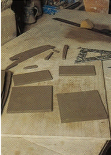
Resim 1.5:Plaka parçaların kesimi
