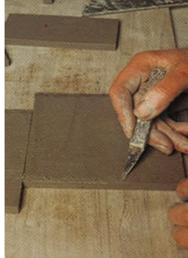
Resim 1.6:Yapıştırma yapılacak yerlerin çentiklenmesi
