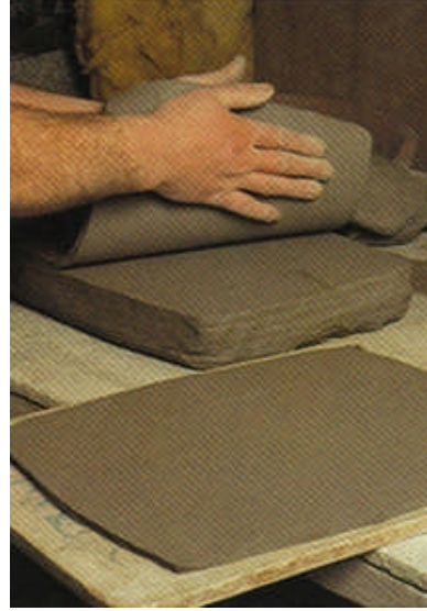
Resim 1. 3: Kesilen plakaların ayrılması
