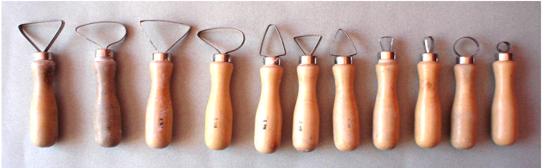
Resim 3.3: Farklı uçlarda ve şekillerde oyma yontma bıçakları
