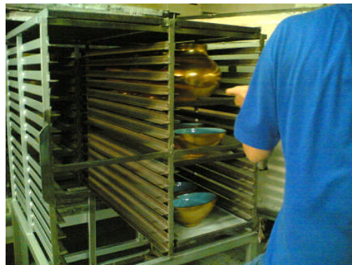
Resim 1. 6: Fırın arabasına ürünün alınması
