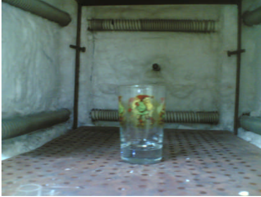
Resim 4.2: Kamara fırında transfer fırınlama
