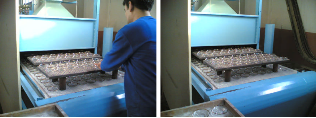
Resim 3.1: Tünel fırın giriş ve ön ısınma bölgesi
