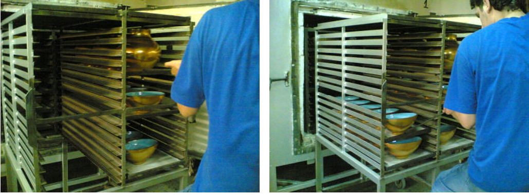
Resim 1.7: Pişen ürünün fırından çıkarılması
