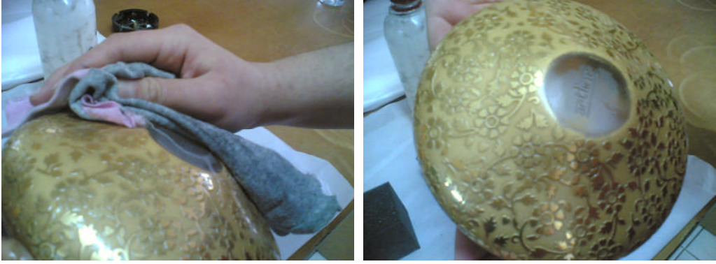
Resim 2.8: Tüylü olmayan bez ile fazlalıkları alma
