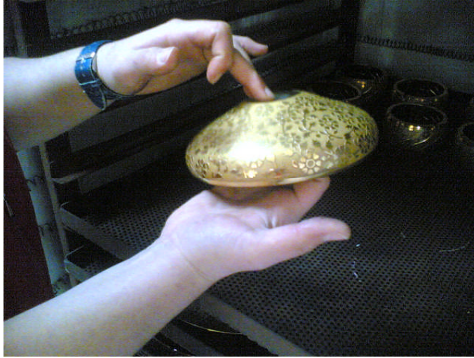
Resim 1.2: Fırına yaldızlı ürün yerleştirilmesi
