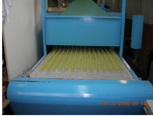
Resim 4.1: Tünel fırında transfer fırınlama
