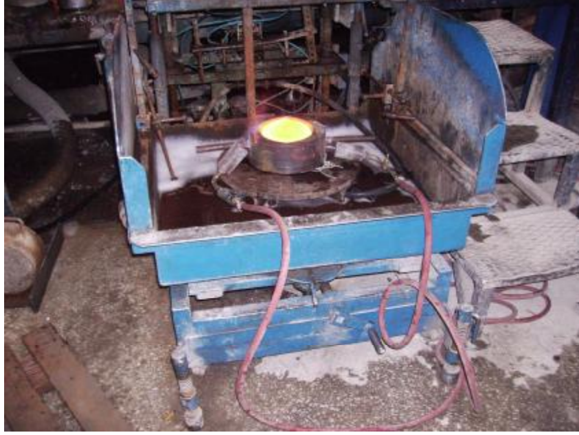
Resim 2.8: Alev bekleri ve kalıbın içini maden ile ısıtma
