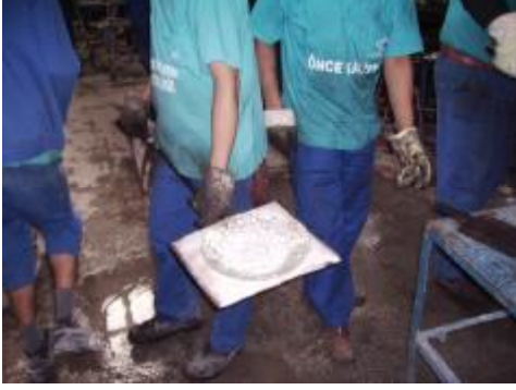
Resim 1.24: Soğumaya bırakılacak camın soğutma (tavlama) fırınına taşıma işlemi
