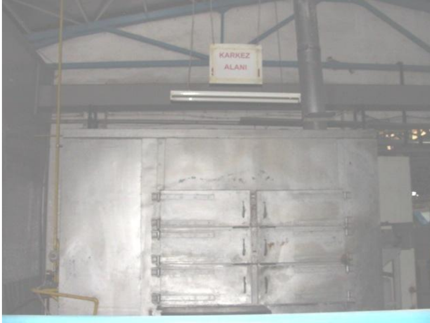
Resim.1.28: Sabit tavlama fırını
