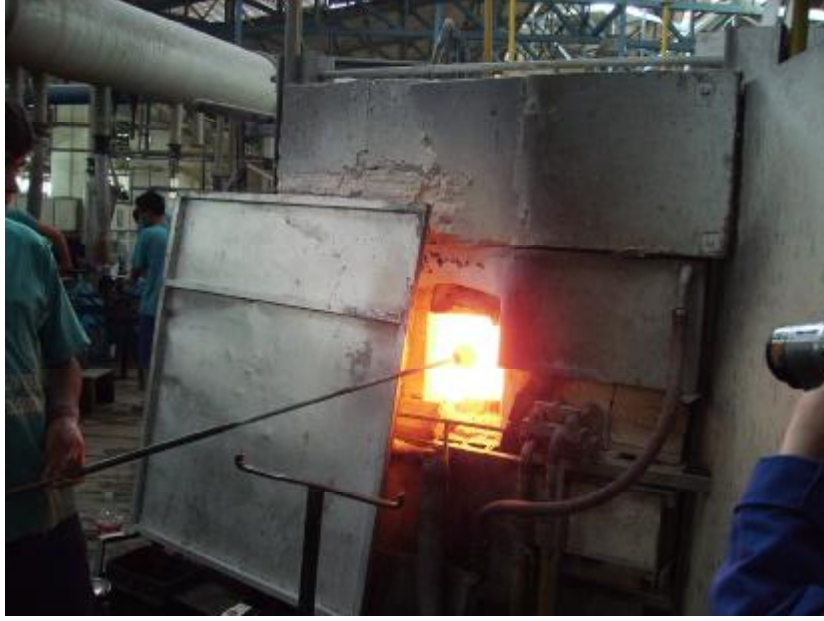
Resim 1.12: Fırına fongayı daldırıp cam sarmak
