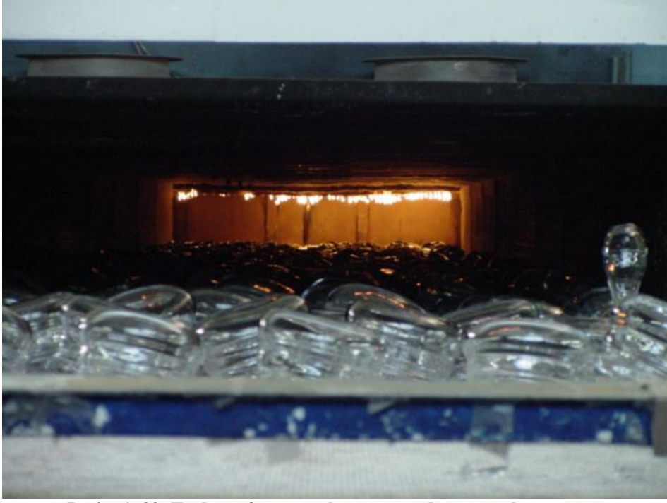
Resim 1. 33: Tavlama firmı soğuktan sıcağı dođru tünel görüntüsü
