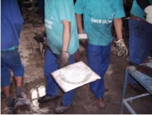
Resim 2.30: Soğumaya bırakılacak camın soğutma (tavlama) fırınına taşıma işlemi
