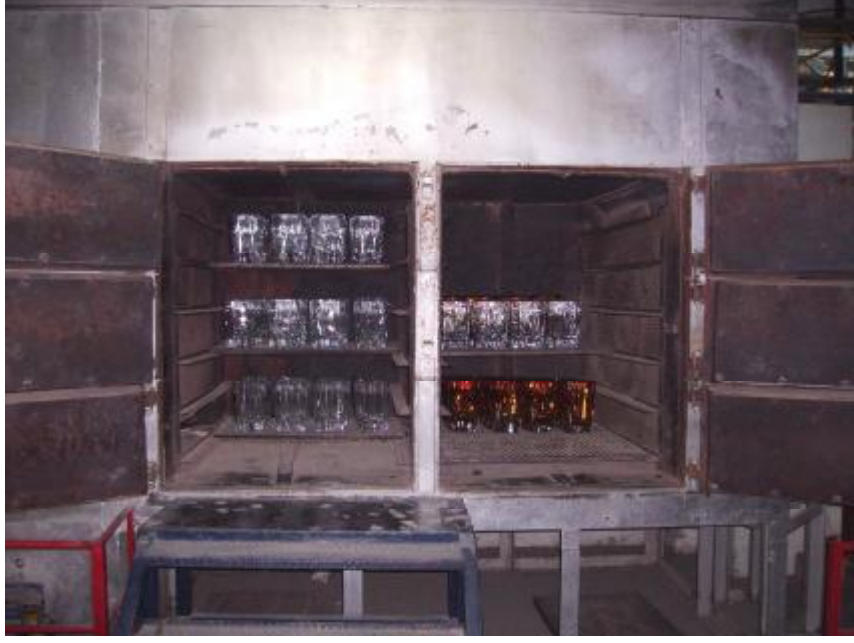
Resim 1.29: Ürün yerleştirilmiş sabit tavlama fırını
