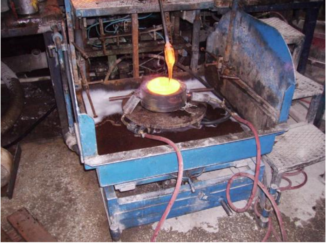
Resim 1.9: Alev bekleri ile ısıtılan kalıbın içine cam akıtma
