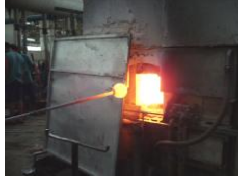
Resim 2.17: Fırına fongayı daldırıp cam sarmak
