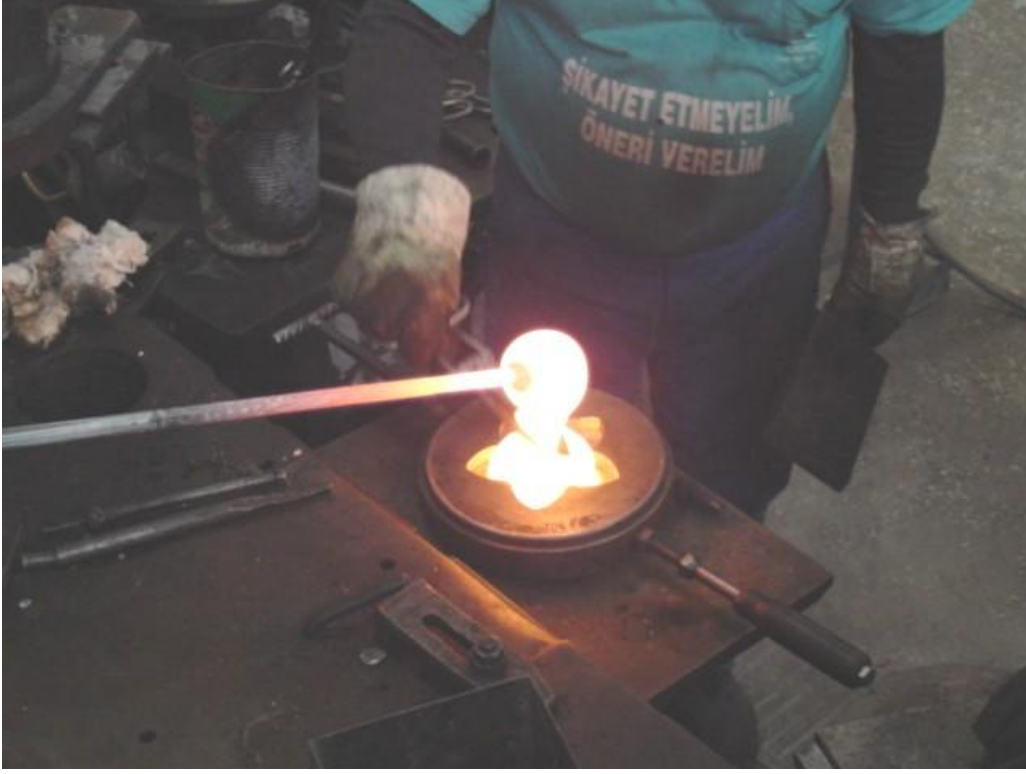
Resim 2.20: Sıcak camı kalıba doldurmak
