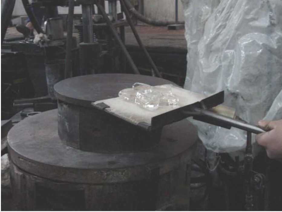
Resim 2.29: Soğuyan ürünün taşıma küreğine aktarılması
