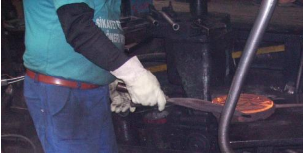
Resim 1.18: Cam taşıma küreği ile düzeltme
