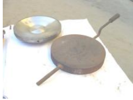
Resim.1.2: Kasnak veya çökertme kalıpta kullanılan şekillendirme pleyti ve çökertme pleyti
