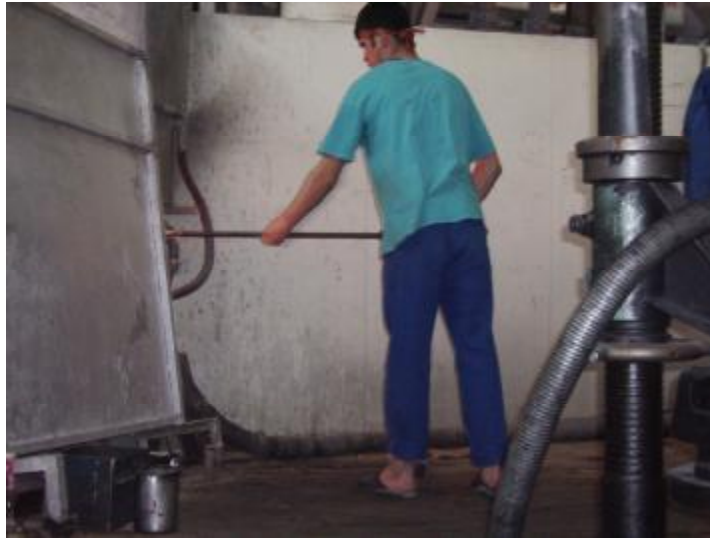
Resim 2.16: Fırından sıcak cam alma
