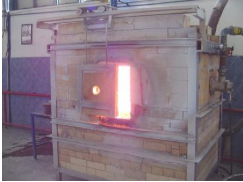
Resim.1.27: Çalışmaya hazır tekli pota fırını
