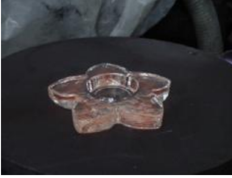
Resim 2.27: Cam kalıptaki sıcak ürünün pleyt üzerinde soğuması
