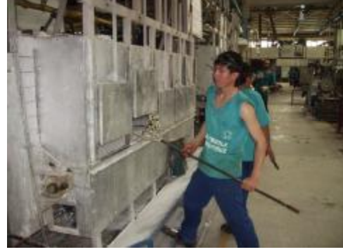
Resim 1.24: Soğumaya bırakılacak camın soğutma (tavlama) fırınına taşıma işlemi
