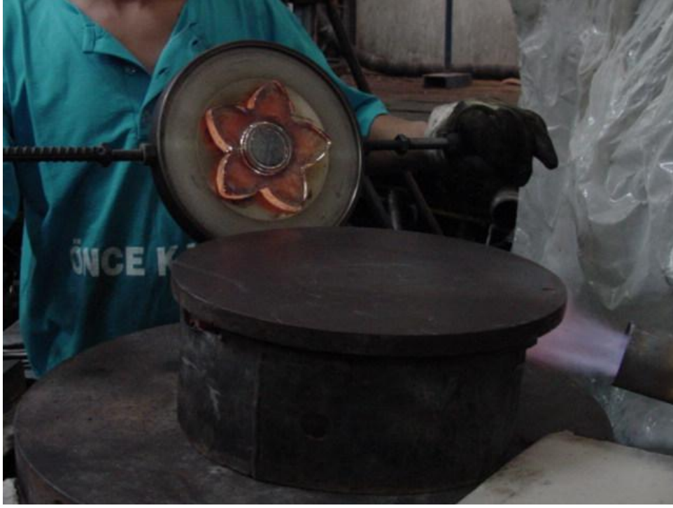
Resim 2.25: Cam kalıptaki ürünün ayrılıp döndürülmesi
