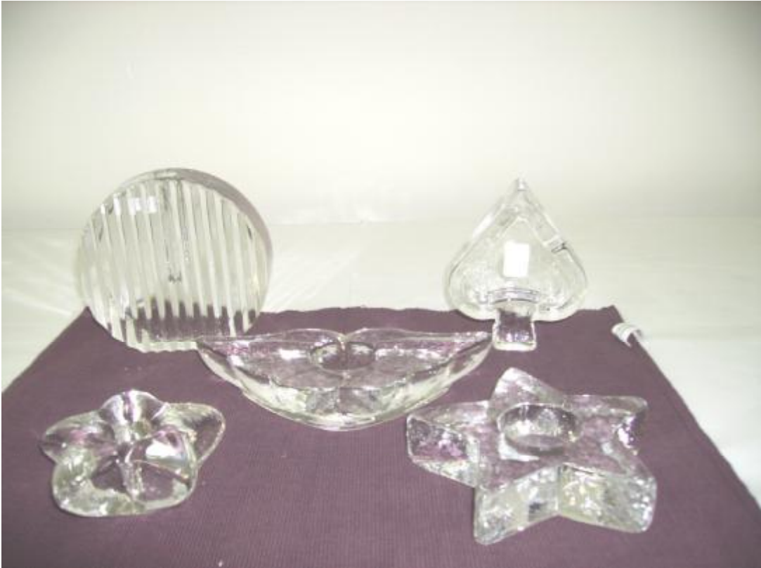
Resim 2.6: Sıvama kalıbı ile oluşan ürünlere örnek
