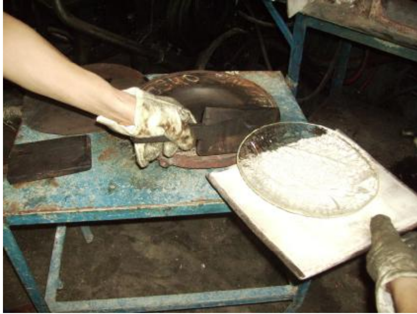
Resim 1.23: Kalıptaki ürünü taşıma küređine aktarılması
