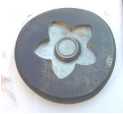
Resim 2.3: Sıvama kalıbı ve oluşan ürüne örnek
