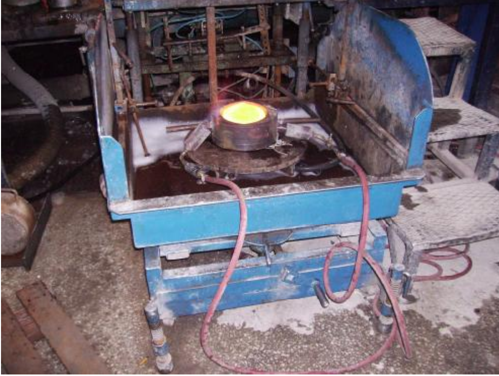
Resim.1.10: Alev bekleri ve kalıbın içini cam ile ısıtma
