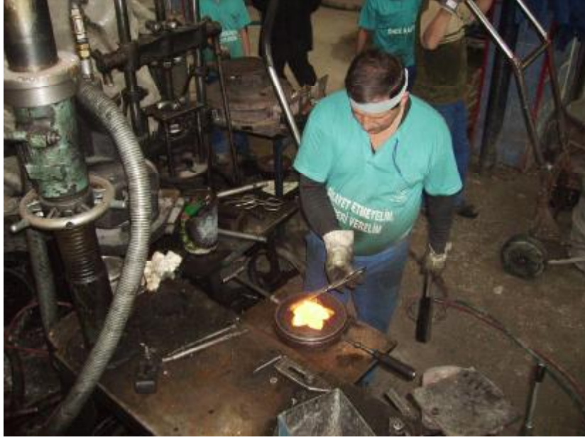
Resim 2.21: Cam kalıp içine konan sıcak cam
