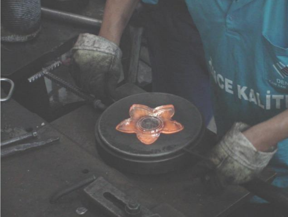
Resim 2.24: Cam kalıbın kapağından ayrılıp döndürülmesi
