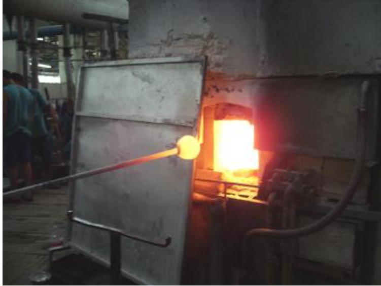
Resim.1.13: Fırına fongayı daldırıp cam sarmak
