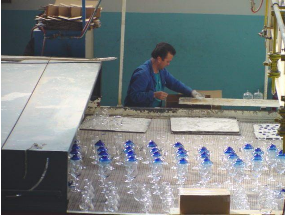
Resim.1.36: Kapeleri kesilecek ürünlerin tavlama fırını sonundan çıkışı
