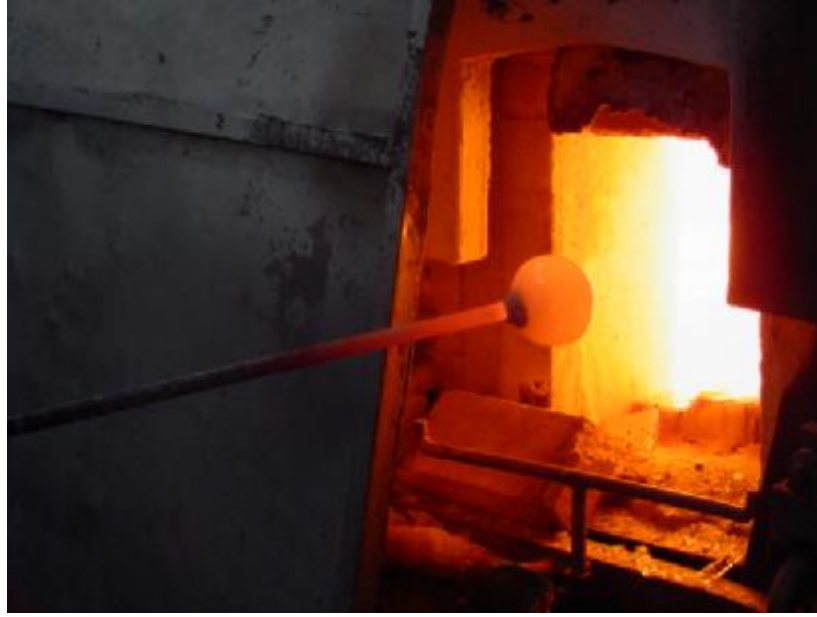
Resim.2.18: Fongaya sıcak camın sarılması
