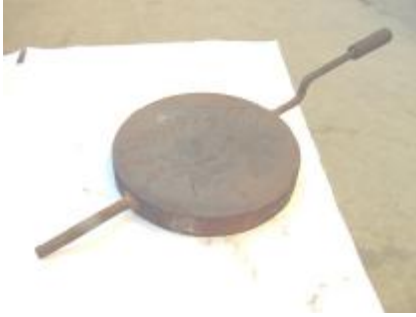
Resim.1.2: Kasnak veya çökertme kalıpta kullanılan şekillendirme pleyti ve çökertme pleyti
