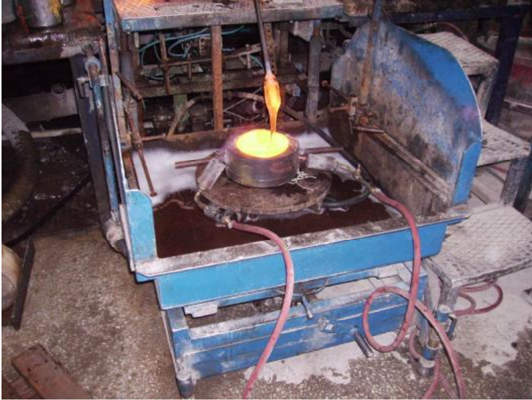
Resim 2.7: Alev bekleri ile ısıtılan kalıbın içine maden akıtma
