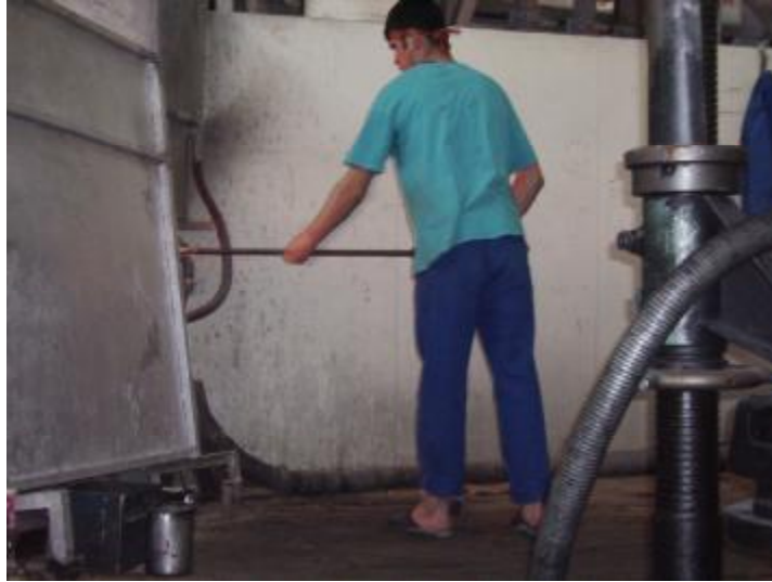
Resim 1.11: Fırından sıcak cam alm
