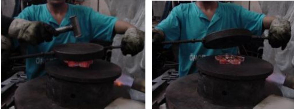
Resim 2.26: Cam kalıptaki ürünün çekiçle ayrılıp soğutma pleyti üzerine taşınması
