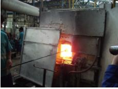
Resim 2.17: Fırına fongayı daldırıp cam sarmak
