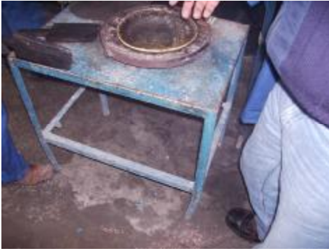
Resim 1.20: Sıcak camın kalıp üzerinde oluşması ve soğuması
