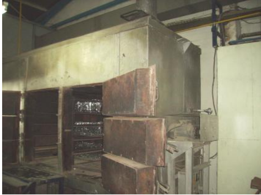
Resim 1.30: Sabit tavlama fırını
