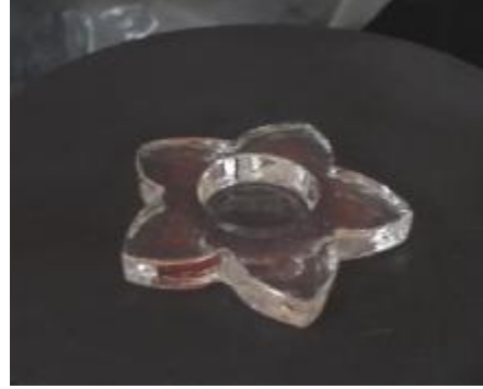
Resim 2.3: Sıvama kalıbı ve oluşan ürüne örnek
