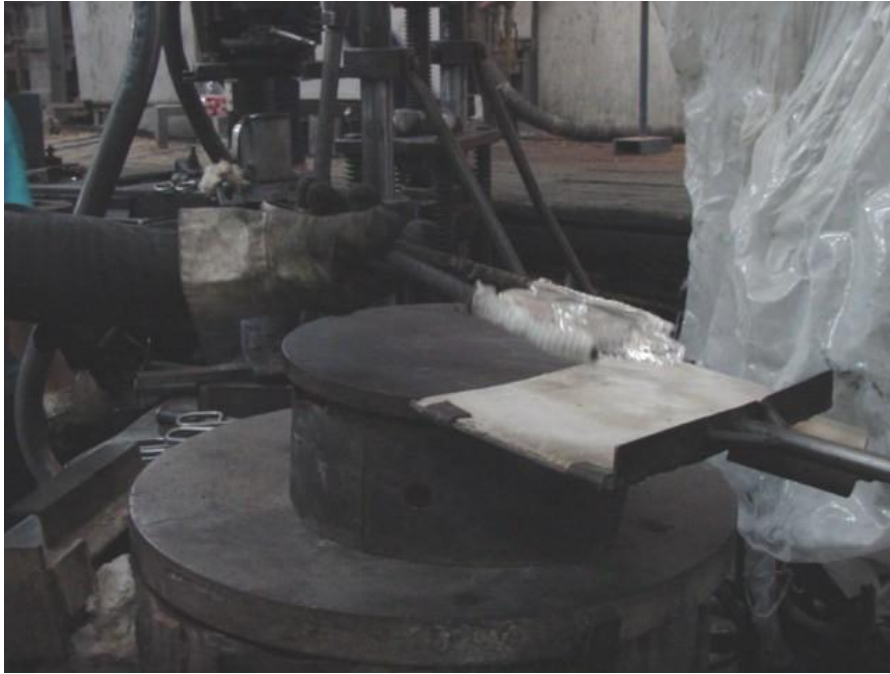
Resim 2.28: Soğuyan ürünün pleytten taşıma küreğine maşa ile aktarılması
