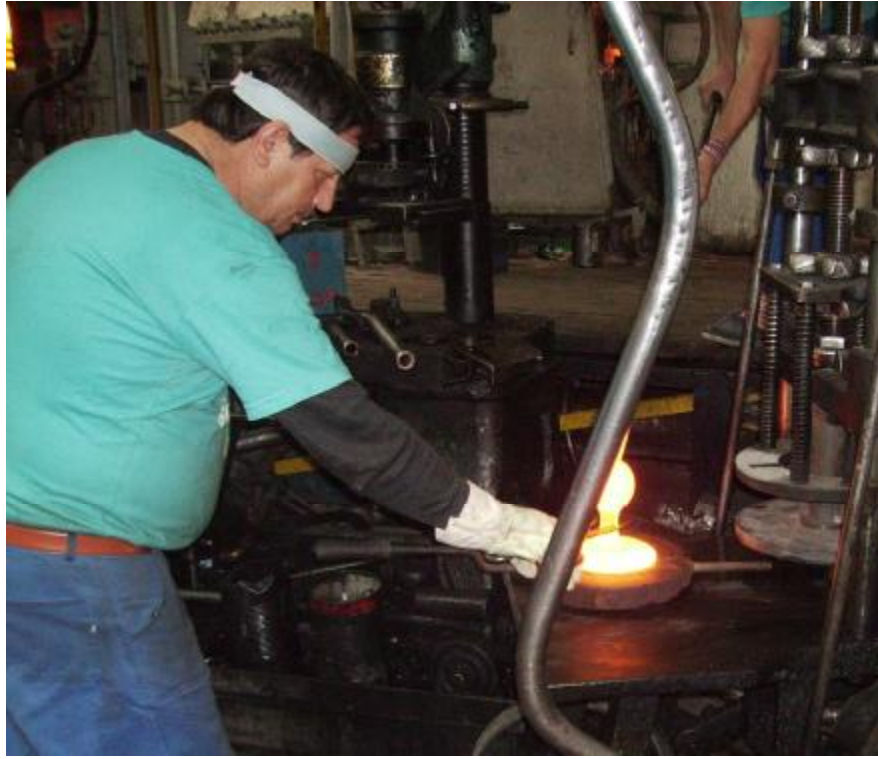
Resim.1.16: Cam makası ile kesme
