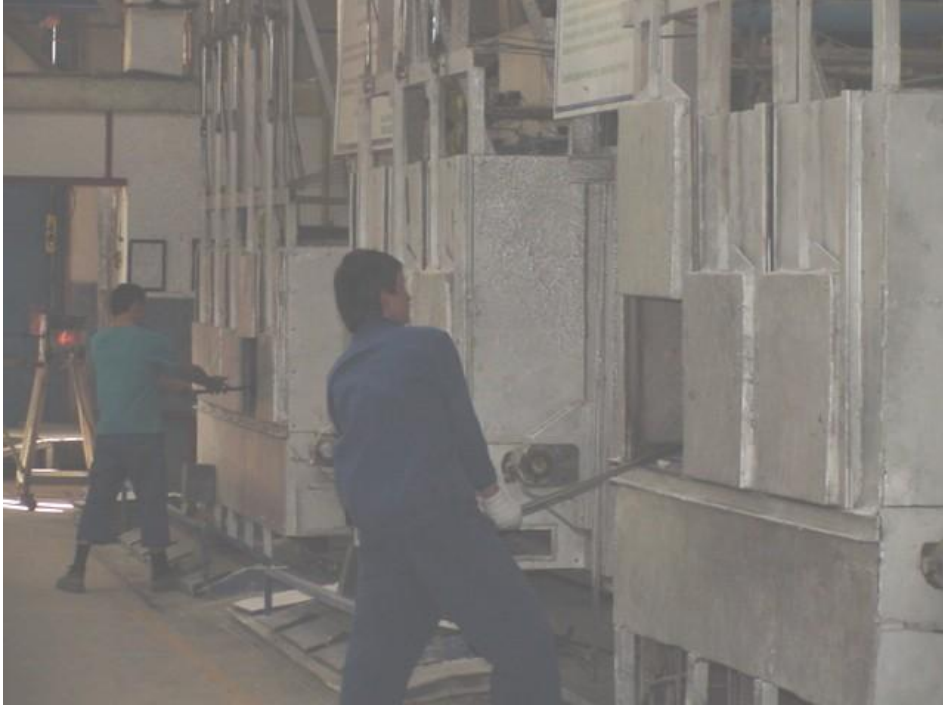
Resim 1.32: Yan yana iki ayrı ürün cinsine göre ayrılmış sürekli tavlama fırınından görüntüler
