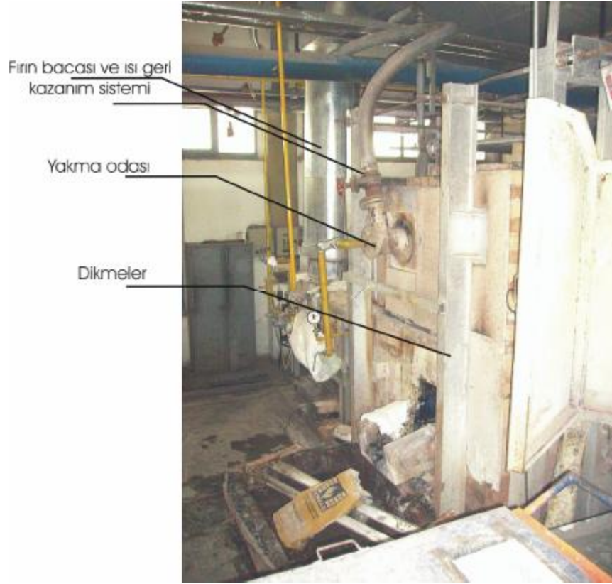
Resim.1.26: Pota fırınının yandan görünümü
