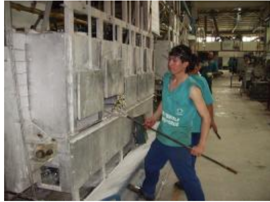
Resim 2.30: Soğumaya bırakılacak camın soğutma (tavlama) fırınına taşıma işlemi
