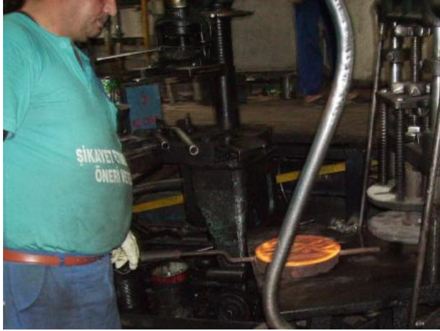
Resim 1.17: Sıcak camın kalıp üzerinde oluşumu
