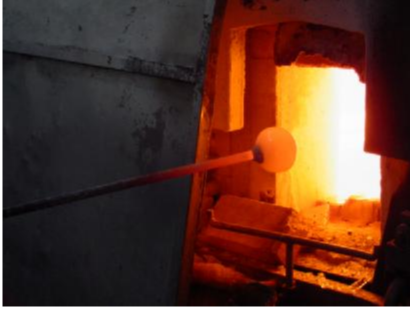
Resim.1.14: Fongaya sıcak camın sarılması
