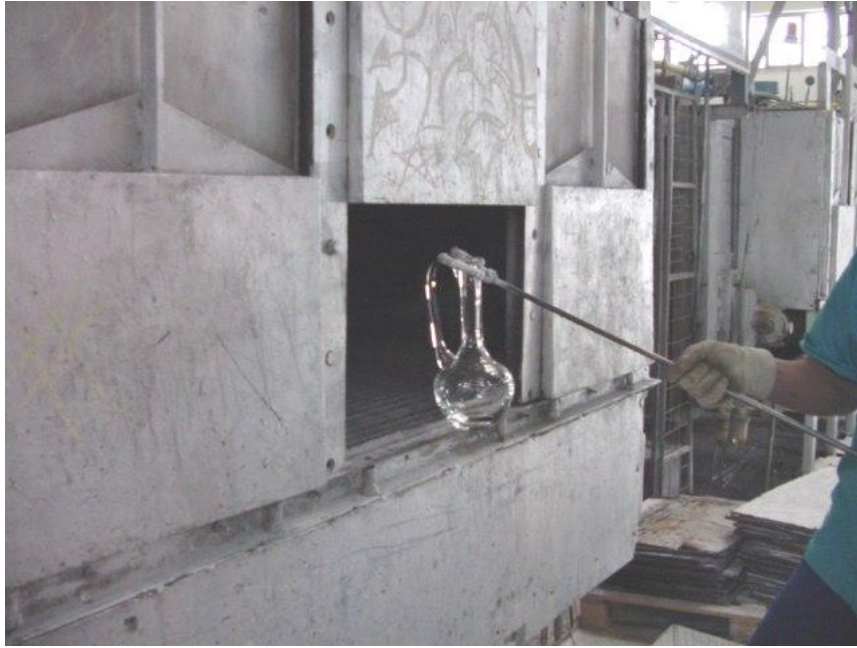
Resim 1.31: Tavlama fırınına kapağı açılarak ürün yerleştirmek
