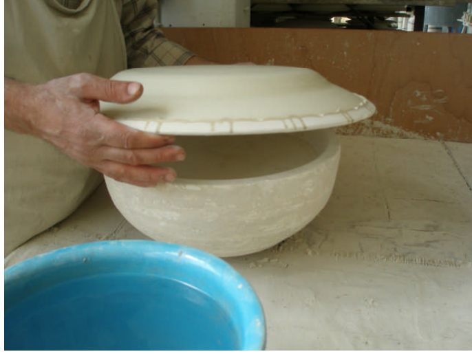
Resim1.1: Şablon kalıbının yerleştirilmesi
