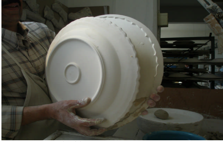
Resim 4.2: Tabağın kalıptan ayrılması
