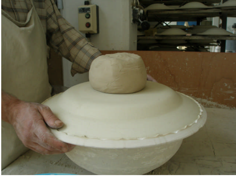
Resim 3.1: Çamurun kalıp merkezine yerleştirilmesi
