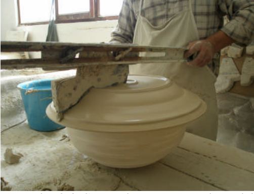
Resim 3.4: Şablon ile tabağın şekillendirilmesi
