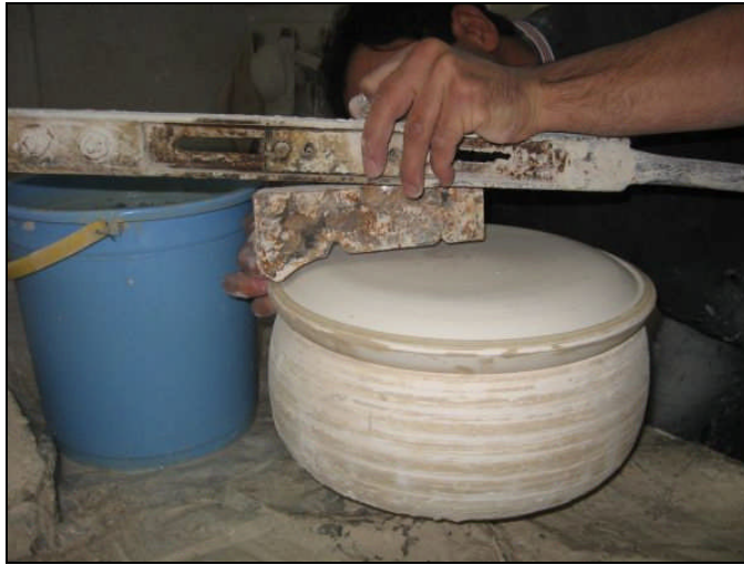
Resim 1.6: Et kalınlığı ayarının yapılması
