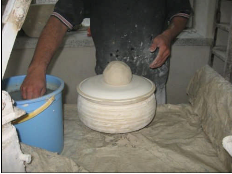
Resim 3.1: Çamurun kalıbın merkezine yerleştirilmesi
