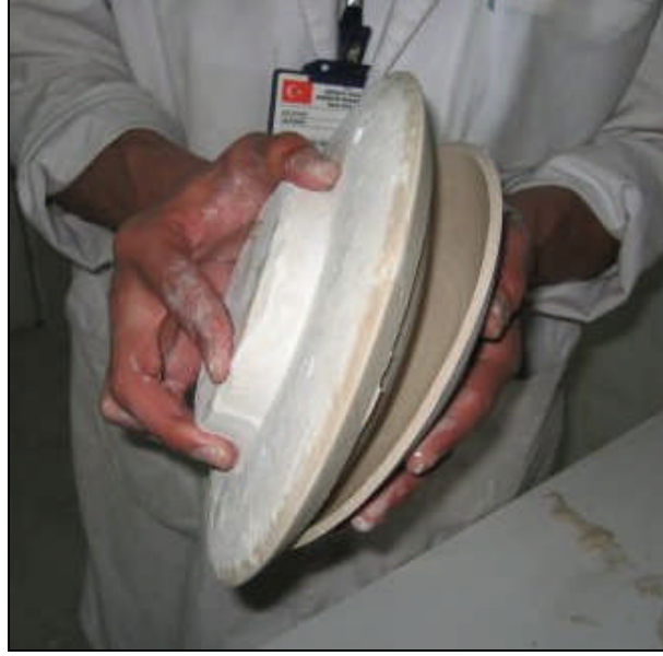
Resim 4.2: Tabağın kalıptan ayrılması
