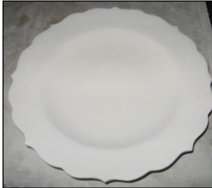
Dış sıvama yöntemi kullanılarak şablon kalıbı ile şekillendirilen 20-30 cm’lik tabak.
