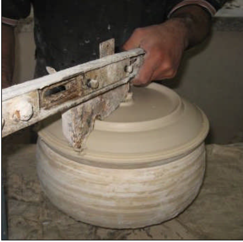
Resim 3.4: Şablon ile tabağın şekillendirilmesi
