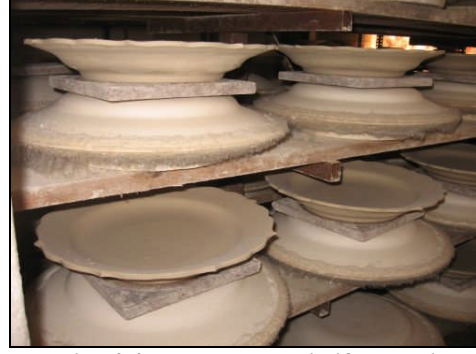
Resim 4.4: Tabağın düz istiflenmesi
