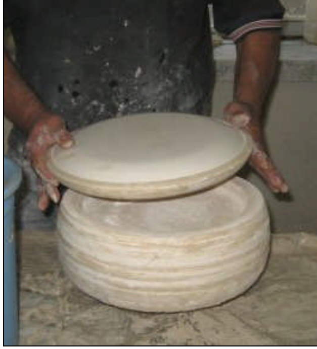
Resim 1.3: Şablon kalıbının yerleştirilmesi
