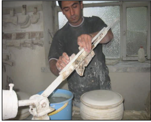
Resim 1.5: Şablonun konsola takılması
