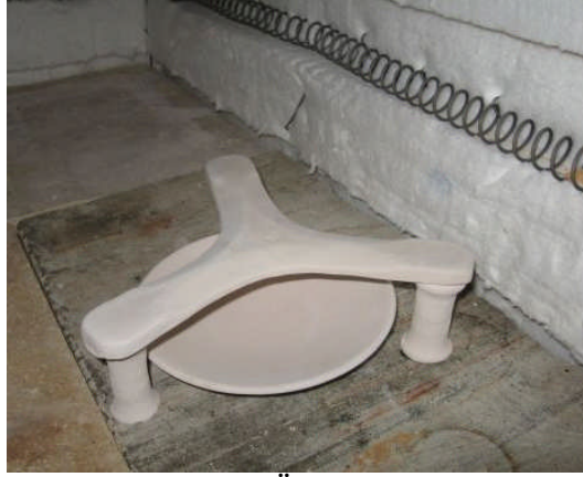
Resim 2.9: Üçgen ayağın yerleşimi
