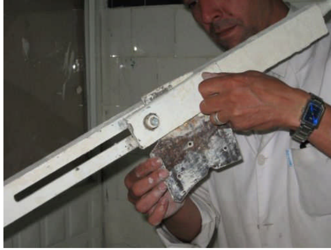
Resim 1.3: Şablonun konsola takılması
