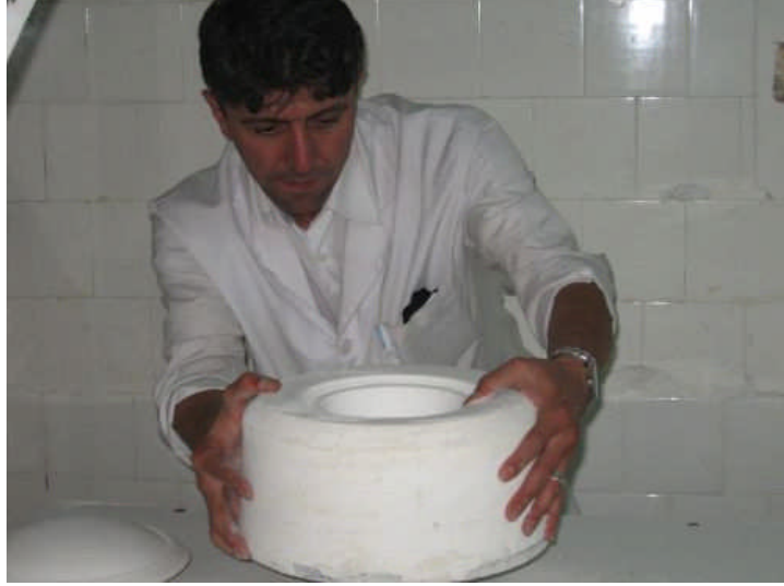
Resim 1.1: Şablon başlığının çark miline vidalanması
