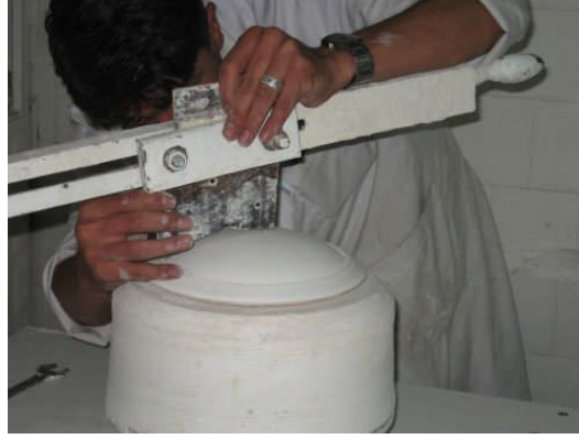
Resim 1.4: Et kalınlığı ayarının yapılması
