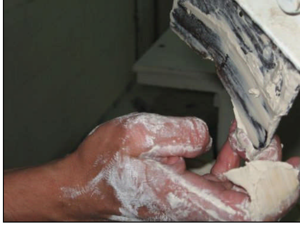
Resim 3. 3: Şablondaki çamurun temizlenmesi
