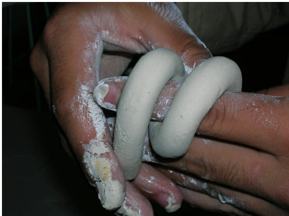
Resim1.9: Çamur kıvam kontrolleri (Plastik kıvamdaki çamur görüntüsü)
