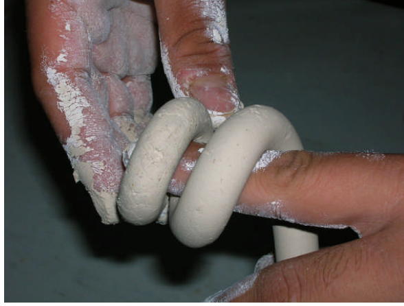
Resim 1.8: Çamur kıvam kontrolleri (Sert kıvamlı çamur görüntüsü)
