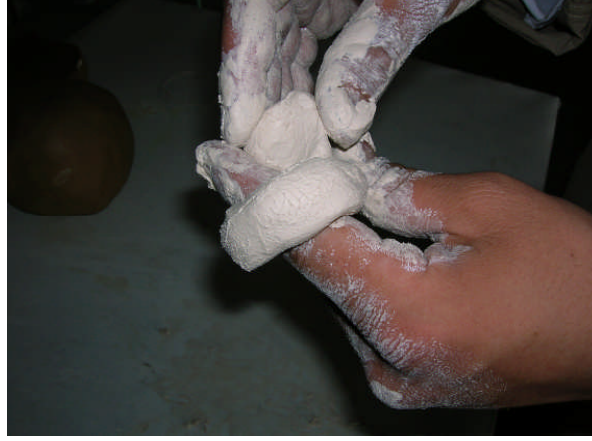
Resim1.10: Çamur kıvam kontrolleri (Yumuşak kıvamlı çamur görüntüsü)
