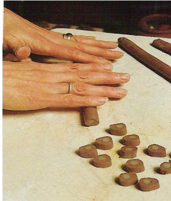
Resim 3.1:Sucuktan(çubuk) silindirik çamur hazırlama
