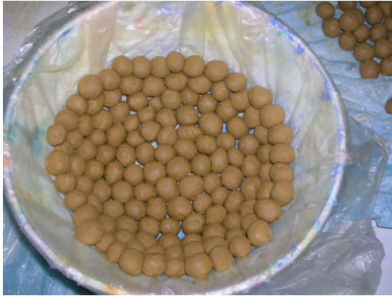
Resim 3.10: Bilyelerin kalıp içine dizilmesi
