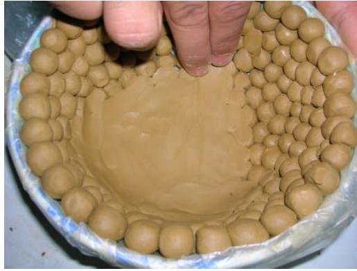
Resim 3.11: Bilyelerin sıvanarak birleştirilmesi
