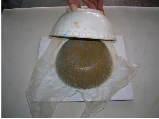
Resim 3.15:Kahbın formdan ayrılması
