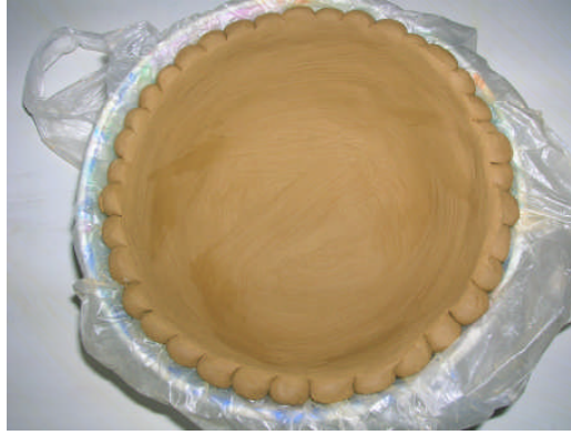
Resim 3.13:Şekillendirilen formun kalıp içinde dinlendirilmesi
