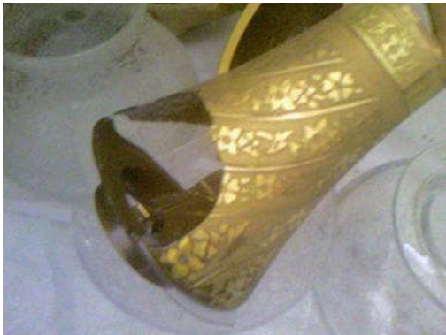
Resim 1.30:Yıldızlı fırınlamada deforme olan ürünler
