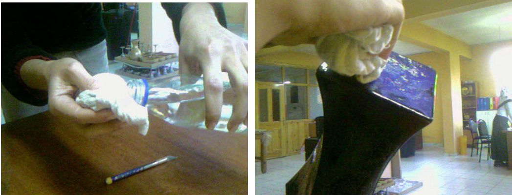
Resim 3.9:Formun tabanına akan yaldızın tinerli bezle temizlenmesi.
