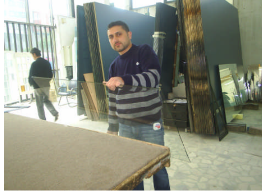
Resim 1.5:Cam tutma şekli
