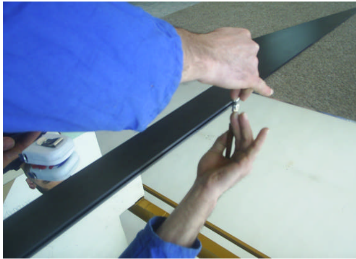
Resim 2.1:Cam kesme işlemi
