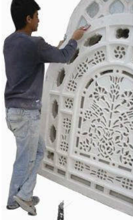
Resim 3.2: Alçı eđesi ile pürüzlerin alınması
