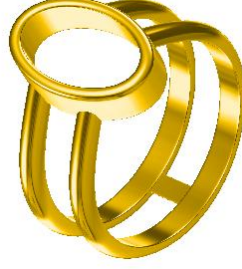
Şekil 2.8: Destek parçasının yüzük koluna kaynatılması
