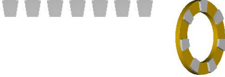
Şekil 2.1: Kontür parçalarının hazırlanarak kaynatılması
