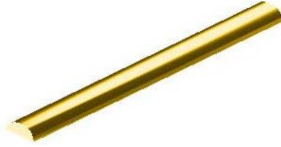
Şekil 2.4: Telin yarım bombe haline getirilmesi
