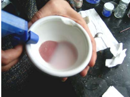
Resim 1.12:Minenin yıkama işlemindeki bulutlanma
