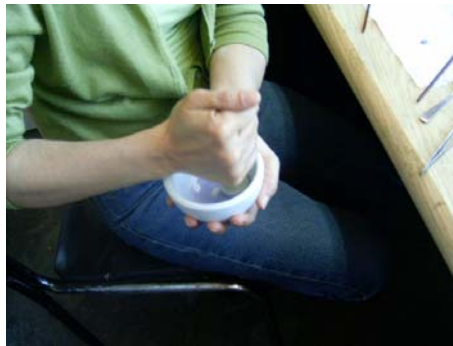
Resim 1.10:Yıkama işlemi sırasında havan tokmağı ile karıştırma
