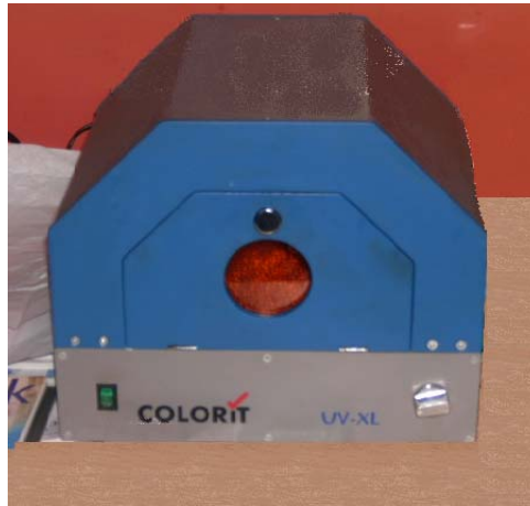
Resim 1.26:Kurutmanın yapıldığı ultraviyole fırın
