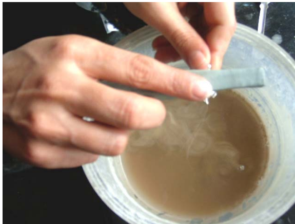
Resim 1.17:Karborundum eğe ile mine yüzeyinin düzeltilmesi
