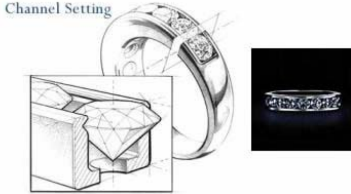
Şekil 4.17: Kanal mıhlama kesit görünüşü
