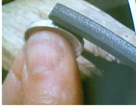
Şekil 6.8: Taş yuvasının tesviyesi
