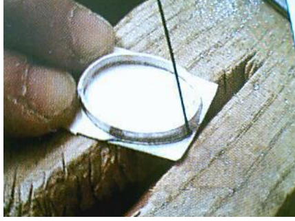
Şekil 6.7: Kutu bezel etrafının kesilerek düzeltilmesi
