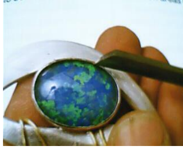
Şekil 6.11 : Engale kalem ile çapak alma işlemi
