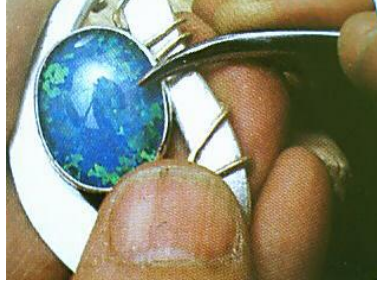
Şekil 6.10: Sıvama işleminin yapılması
