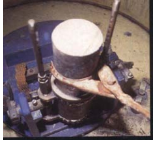
Resim 3.1: Derecenin santrifüj döküm makinesine yerleştirilmesi
