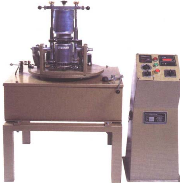
Resim 2.1: Santrifüj döküm makinesi
