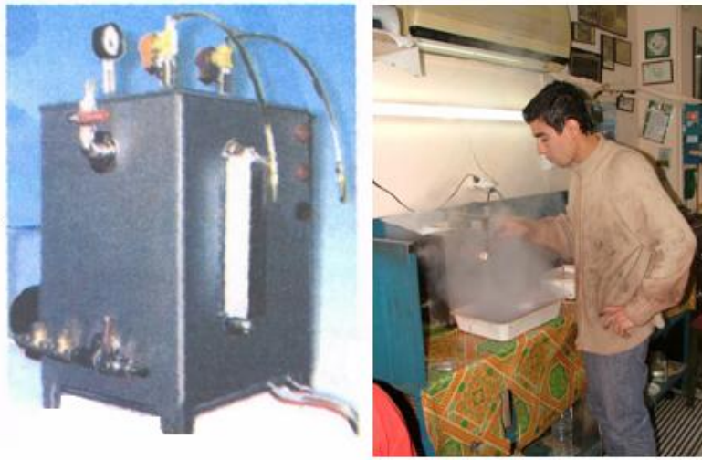
Resim3.3: İstim makinesi ve istimde yıkamanın yapılışı
