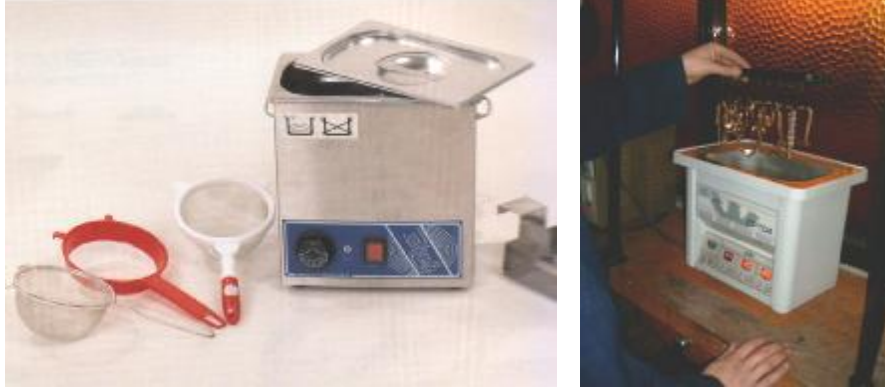
Resim 3.1: Ultrasonik yıkama makinesi ve ürün yıkama
