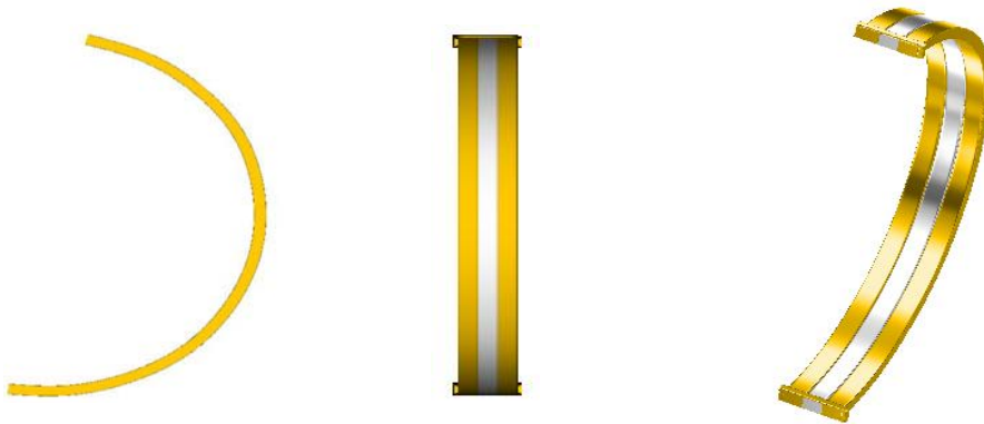
Şekil 3.6: Bilezik kollarının malafada yuvarlatılması
