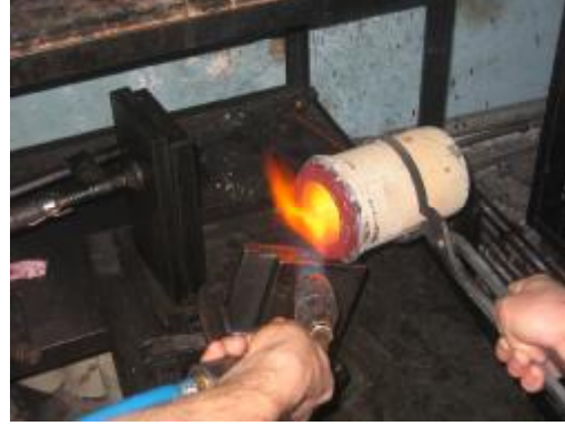
Resim 2.10: Eriyen metalin şideye dökülmesi
