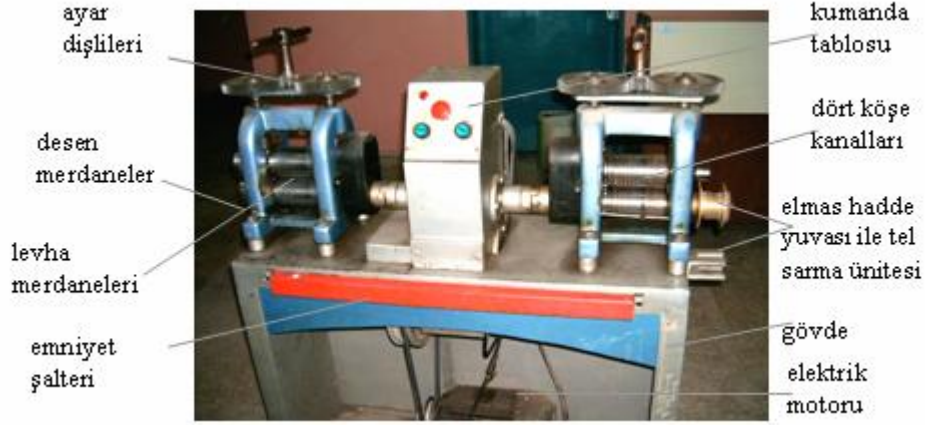
Resim 5.1: Haddeme makinesi ve kısımları
