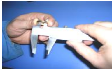
Resim 4.5: Doğrudan ölçme işlemi
