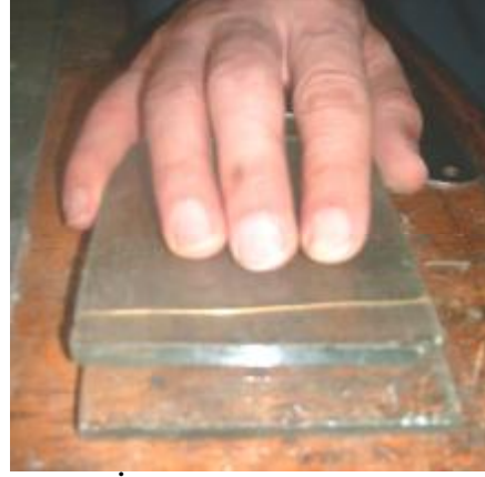
Resim 1.7: İki düzlem arasında tel düzeltme
