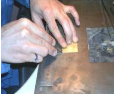
Resim 2.6: Çizim yöntemiyle markalamanın yapılışı
