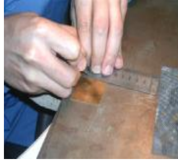
Resim 2.6: Çizim yöntemiyle markalamanın yapılışı
