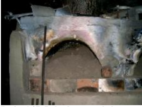
Resim 1.27: Buharlı yöntem kal ocağı
