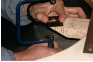
Resim 2.9: Kesim sırasında parçanın tutulması
