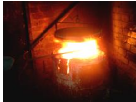
Resim 1.18: Döküm için ocağın hazırlanması
