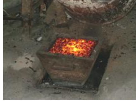
Resim 1.20: Kalıptaki metalin soğumaya bırakılması
