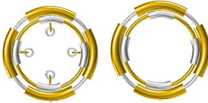
Şekil 3.10 : İçteki şarnel ve bağlantı parçalarının montajının yapılması
