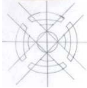
Şekil 3.3 : İçteki şarnel yerlerinin belirlenmesi
