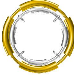
Şekil 2.4 : Orta şarnel parçasının birleştirilmesi
