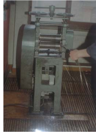
Resim 1.4 : Alaşım telinin istenilen ölçüye getirilmesi
