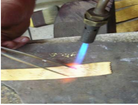
Resim:3.2: Tellerin kaynatılması
