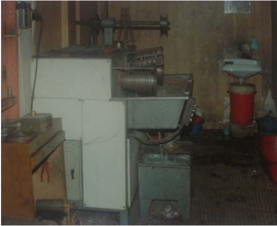
Resim 1.4 : Alaşım telinin istenilen ölçüye getirilmesi
