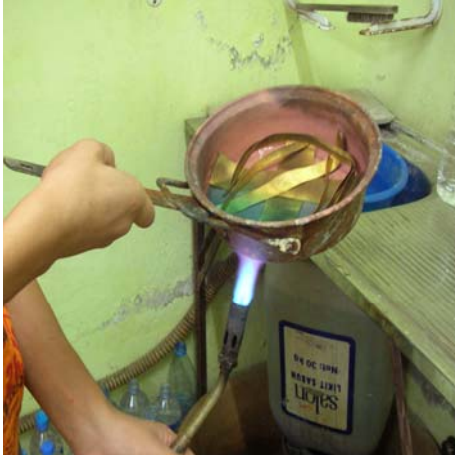
Resim 3. 1:Hasır örgünün tavllanması ve zaç yağında temizlenmesi
