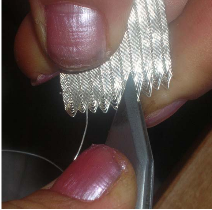
Resim 2.7 : Hasırın çift ile düzeltilmesi
