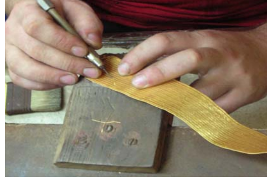
Resim:3.2: Tellerin kaynatılması
