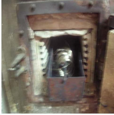
Resim 1. 7: Tellerin elektrikli tavlama ocağında tavllanması
