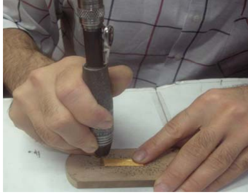
Resim 3.11: Küpe kilit sisteminin sarmalıklarının hazırlanması ve matkapla delinmesi
