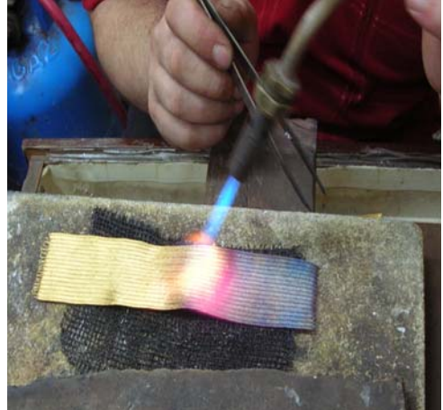
Resim 3. 1:Hasır örgünün tavllanması ve zaç yağında temizlenmesi
