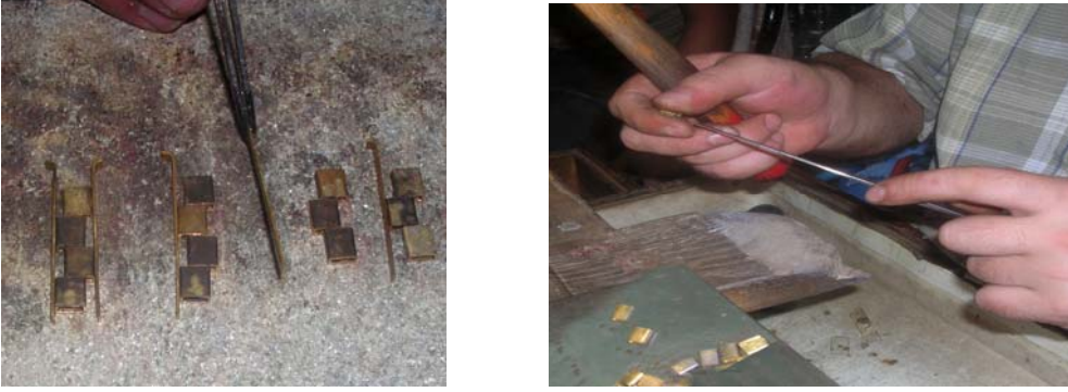
Resim:3.5: Kilit şarnellerinin hazırlanması ve destek parçasına kaynatılması
