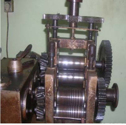
Resim 1.9: Levhanın silindirde hazırlanması ve tavlanaması
