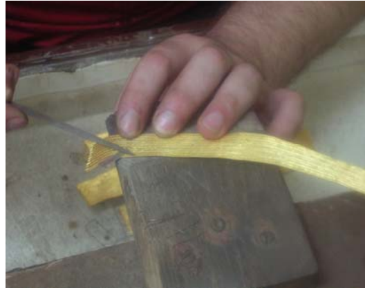
Resim:3.3: Kaynak yapılmış tellerin tesviyesi
