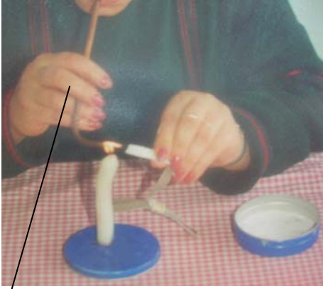
Resim 2.11: Ters Kaynağın Yapılışı
