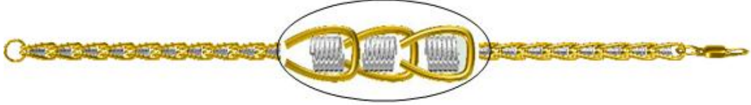
Şekil 2.17 : Kilit parçasının montajı
