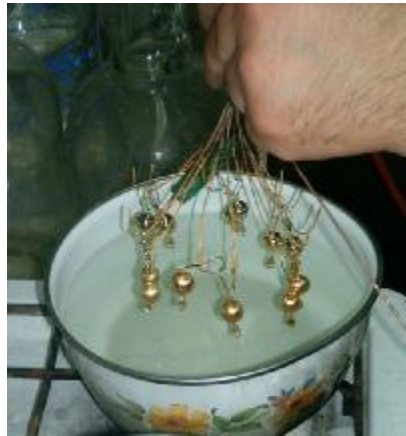
Resim 3.1: Yaldız banyosu ve ürünün batırılması
