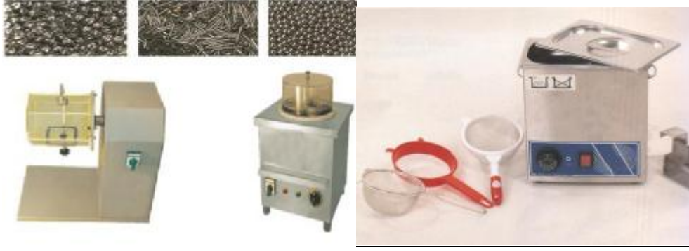
Resim 2.2: Temizlemede kullanılan araç gereçler (bilyalı dolap ve yıkama makinesi)
